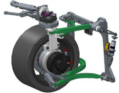
(b) CAD-Zeichnung des entwickelten Fahrwerks des Projekts OmniSteer [NAMB19]. Die Lenker sind in grün hervorgehoben.
