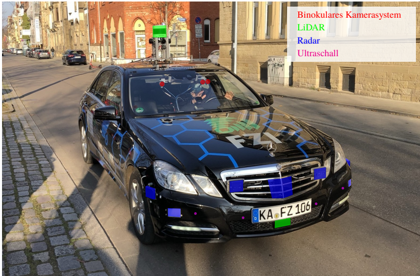
Abbildung 1.1: Sensorik des Forschungsfahrzeugs BerthaOne. Für die linke Kamera des binokularen Kamerasystems steht eine Graustufen- oder eine Farbkamera zur Verfügung.
