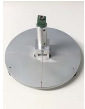
(c) Kleine Halterung mit Validierungsteil ValZahnrad
