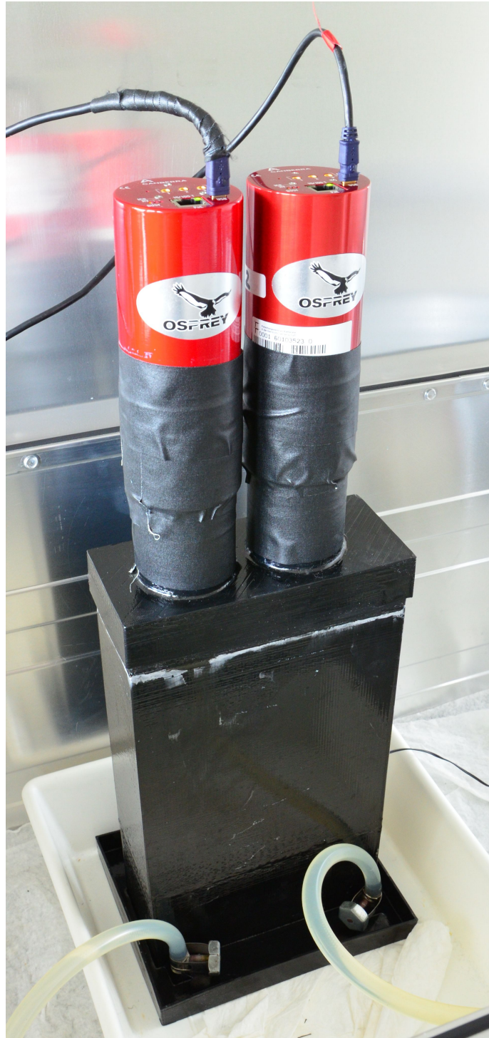
Abbildung 6.46: Detektoraufbau mit Aufsatz für zwei Photomultiplier, um eine Koinzidenzmessung zu ermöglichen.
