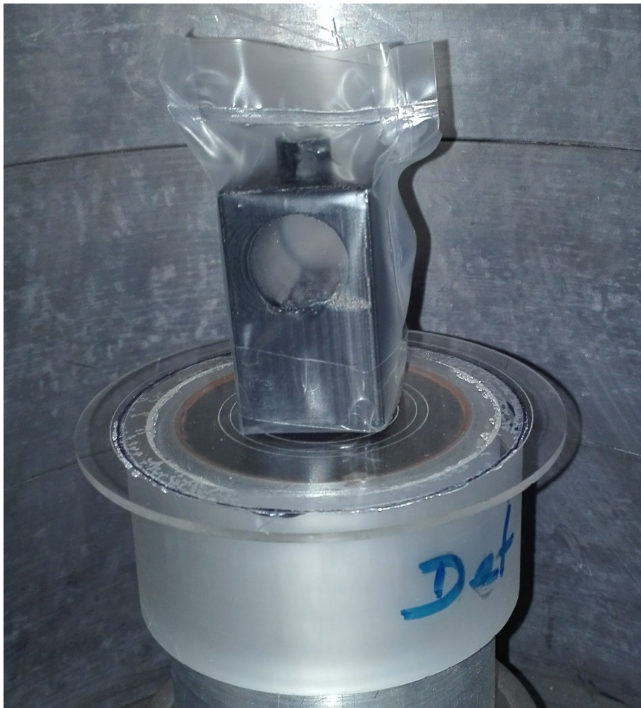
Abbildung 6.2: Testquader auf Germaniumdetektor zur \gamma -spektrometrischen Bestimmung der Oberflächenkontamination. Zum Schutz vor einer möglichen Kontamination des Detektors ist der Testquader versiegelt.
