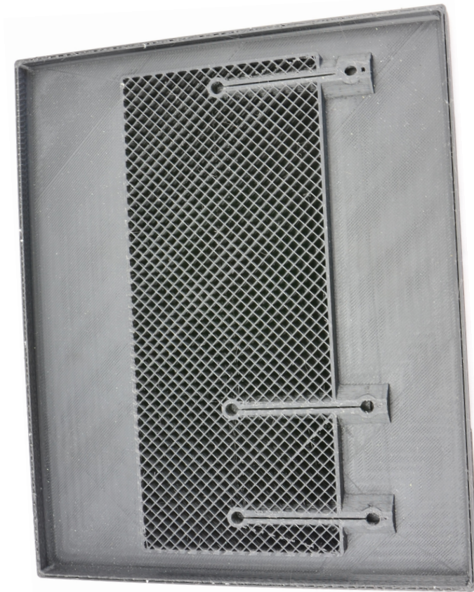
Abbildung 5.4: Nur teilweise gedruckte Bodenplatte des Detektorgehäuses analog zur in Abbildung 5.3 dargestellten Visualisierung.
