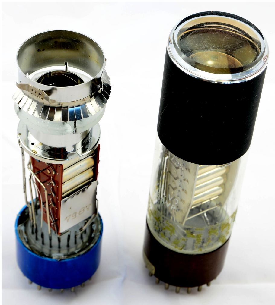
Abbildung 3.8: Links: Photomultiplier mit entferntem Glasgehäuse. Rechts: intakter Photomultiplier. Zu erkennen sind neben der Photokathode auch die Dynoden und ihre elektrischen Anschlüsse für die Spannungsversorgung.
