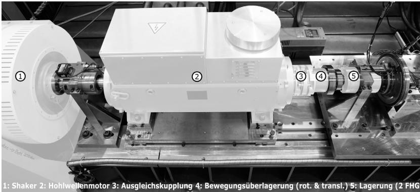
Abbildung 8.4: Umgesetztes Koppelsystem zur Ermöglichung torsionaler und axialer Wechselwirkungen mit ZMS-Primärseite als Sul (Berger et al., 2018)
