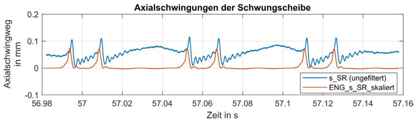
Abbildung 8.27: Gefilterter und ungefilterter Zeitverlauf des Wegs des ZMS-Primärseitenzentrums
