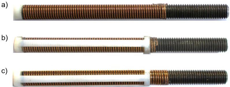
Abbildung 6.18: Darstellung der Versuchsmuster mit (2:y:z), Abdeckung des Bohrlochgrundes, und (x:3:z), Abdeckung des Gewindeganges, mit den verschiedenen Stufen des Faktors 3: keine Unterbrechung der Verbundfläche (0 %) (x:y:1) (a), geringfügige (12,5 %) Abdeckung der Verbundfläche (x:y:2) (b) und großflächige (50 %) Abdeckung der Verbundfläche (x:y:3) (c)
