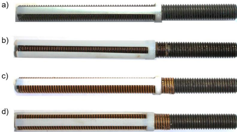
Abbildung 6.15: Kombinationen aus dem Versuchsplan mit der ersten Stufe des Faktors 1 mit geringfügiger (12,5 %) bzw. großflächiger (50 %) Abdeckung des Verbundes, jeweils mit Gewindegrundabdeckung (a (1:2:2) und b (1:2:3)) bzw. Auffüllen des Gewindegangs (c (1:3:2) und d (1:3:3))
