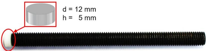
Abbildung 6.3: Gewindestange mit aufgeklebtem weißem Gestaltelement an der Gewindestangenstirnfläche mit dem Außendurchmesser  $d_a = 12$  mm und der Dicke  $t = 5$  mm zur Darstellung der Faktorstufe (2:y:z)
