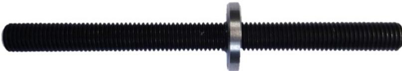
Abbildung 6.5: Gewindestange mit axialem Element, einer Stahlunterlegscheibe zur Darstellung der Faktorstufe (3:y:z) mit Innendurchmesser  $d_i = 12$  mm, Außendurchmesser  $d_a = 28$  mm und Dicke  $t = 5$  mm
