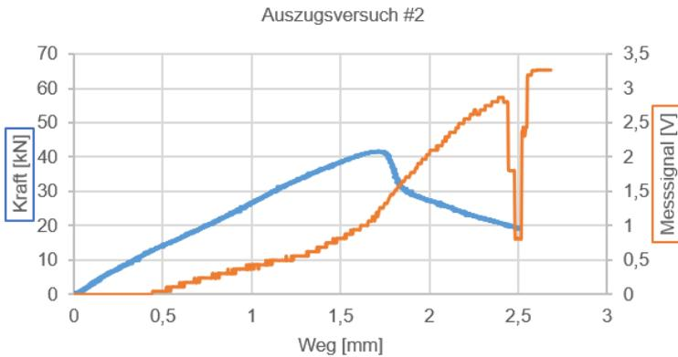
Abbildung 7.17: Verlauf der Kraft und des Messsignals über den Maschinenweg des zweiten Auszugsversuches
