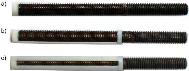
Abbildung 6.17: Variation der Unterbrechung der Verbundfläche z mit der Faktorzusammensetzung (2:2:z) ‚Abdeckung des Bohrlochgrundes‘ und ‚Abdeckung des Gewindegrundes‘
