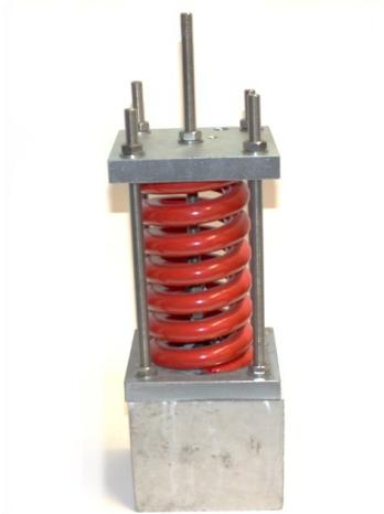
Abbildung 7.22: Vorgespannter mechatronisierter Verbundanker mit Federpaket in Betonwürfel (Neumayer, 2019)
