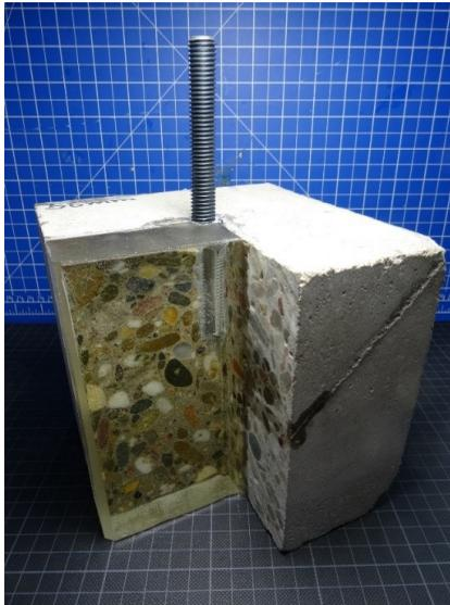
Abbildung 5.6: Fertiger In Situ-Erkenntnisprüfstand mit Epoxidsichtfenster für den Auszugsversuch mit enger Abstützung
