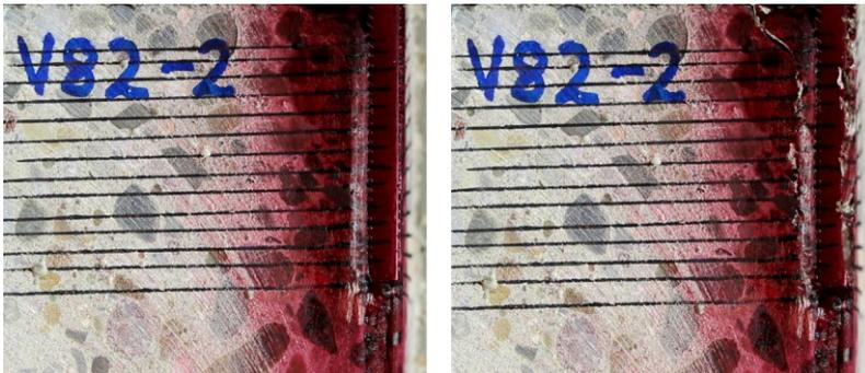
Abbildung 5.10: Tastversuch eines In Situ-Erkenntnisprüfstandes mit Rastermarkierung und Rissprüfspray bei keiner Belastung (links) und beim Erreichen der Auszugskraft (rechts)
