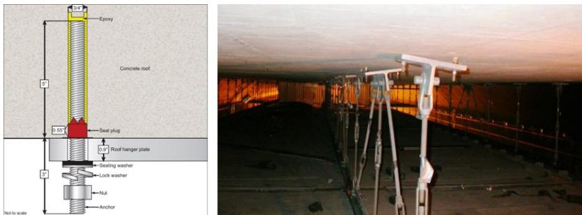
Abbildung 2.16: Schematische Darstellung des eingesetzten Epoxidsystems (links) und versagte Verbundankersysteme aus den Untersuchungen der Deckenabhängungen weiterer Tunnelsegmente (rechts) aus dem Unfallbericht des National Transportation Safety Boards (Rosenker et al., 2007)
