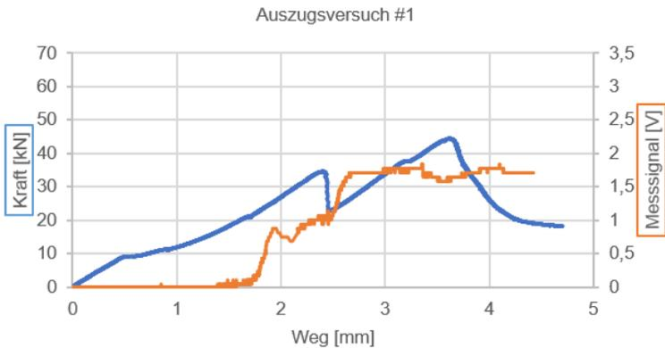
Abbildung 7.15: Kraft-Weg-Verlauf des ersten Auszugsversuches mit eingezeichnetem Messsignal
