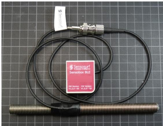
Abbildung 7.11: Prototyp des konstruierten Impedanzsensors mit Messelektronik der Firma SENSOSURF mit integrierter Messdatenübertragung mittels BLUETOOTH LOW ENERGY (BLE)
