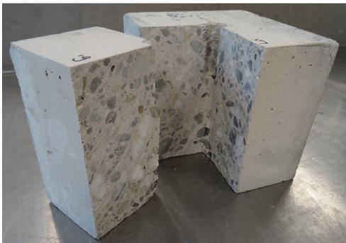
Abbildung 5.2: Betonprüfkörper nach Erstellung des Bohrlochs und anschließendem Aussägen eines Viertels des Würfels
