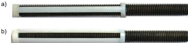
Abbildung 6.16: Versuchsmuster mit der Faktorzusammensetzung mit geringfügiger (12,5 %) (2:1:2) (a) und großflächiger (50 %) (2:1:3) (b) Abdeckung des Gewindegrundes und ‚Element im Bohrlochgrund‘
