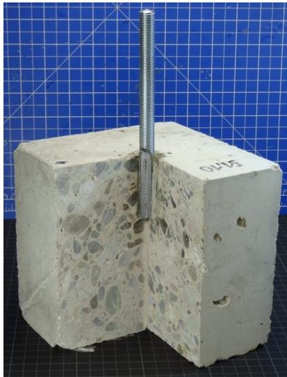
Abbildung 5.9: Beispielhaft einer der verwendeten In Situ-Erkenntnisprüfstände ohne Epoxidsichtfenster
