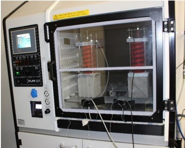
Abbildung 7.24: Prüfkörper in der Salzsprühnebelkammer zur Ermittlung des Einflusses von Feuchtigkeit oder korrosiver Medien auf die mechatronisierten Verbundanker (Neumayer, 2019)
