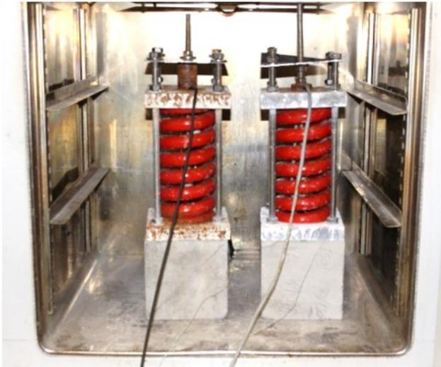
Abbildung 7.23: Zwei vorgespannte Prüfkörper im Ofen (Neumayer, 2019)
