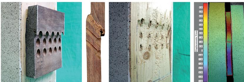
**Bild 5.3:** Versagen des KPH auf Längsdruck und starke Durchbiegung der Verbinderplatten der Reihe 5.
