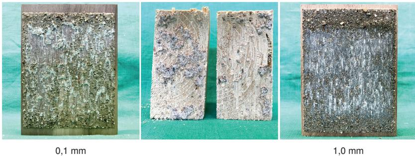
**Bild 4.12:** Unterschiedliches Versagen des Klebebandes mit Klebeschichtdicke von 0,1 mm und 1,0 mm.
