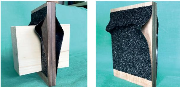
**Bild 4.13:** Adhäsives Versagen der Beschichtung.
