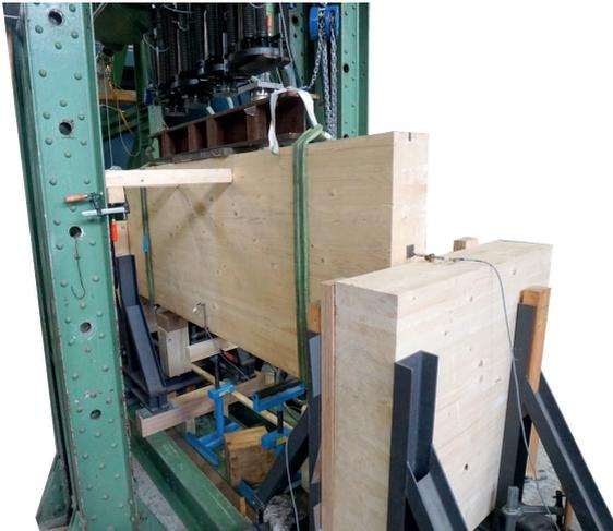
**Bild 6.1:** Versuchsaufbau HT-NT-Träger.
