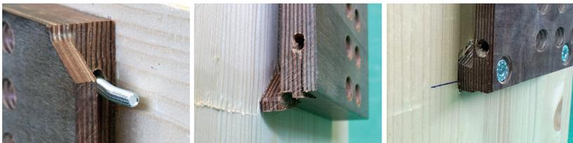
**Bild 5.9:** Versagensarten der Prototypen bei Belastung senkrecht zur Einschubrichtung.
