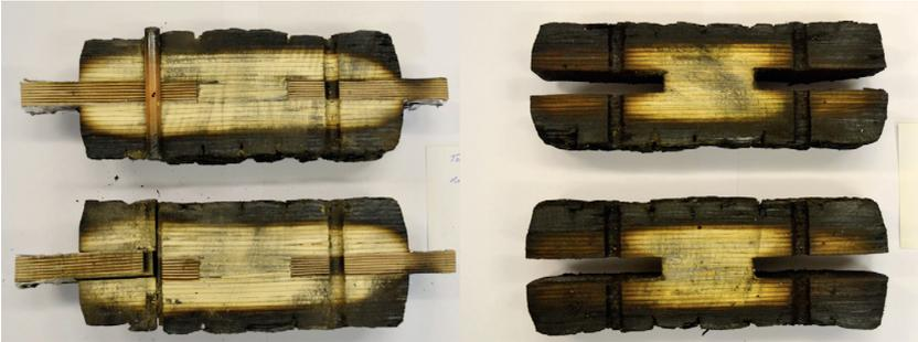
**Bild 3.4:** Schnitt durch eine Verbindung mit Knotenplatten aus KPH (links) und Stahl (rechts) nach 50 min Brandversuch (Quelle: Brandon et al. [6]).
