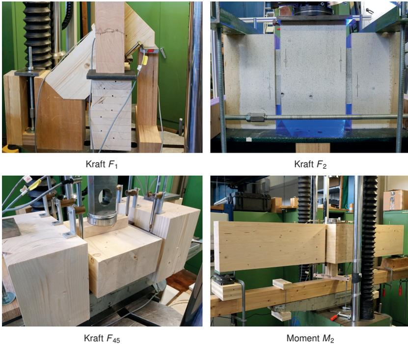
Bild 5.6: Versuchsaufbauten für versch. Belastungsrichtungen der Prototypverbinder.
