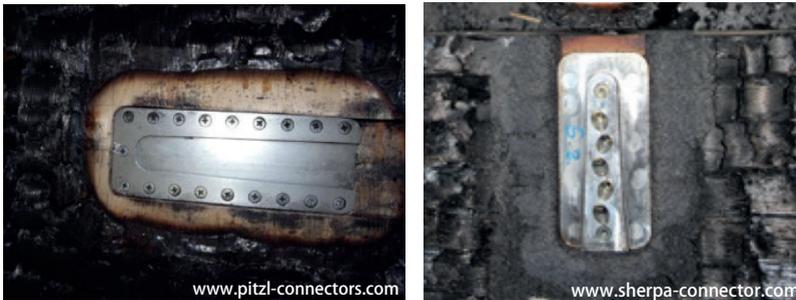
**Bild 2.4:** Links: Brandschutz von Verbindern durch Ummantelung mit Holz. Rechts: spezielles Brandschutzlaminat.
