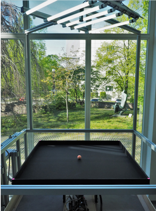
Abbildung 6.12: Ball-auf-Platte-System des Instituts für Regelungs- und Steuerungssysteme am Karlsruher Institut für Technologie, das für die modellfreie, ADP-basierte Solltrajektorienfolgeregelung verwendet wird.
