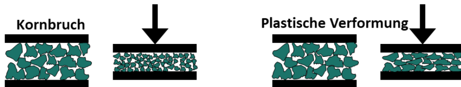
Abbildung 2-1: Ursachen für das kompressible Verhalten von Filterkuchen (nach [24]).
