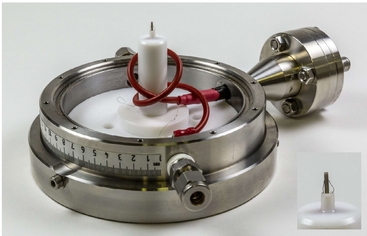
Abbildung 3.1: Fotografie der am Deutschen Elektronen-Synchrotron (DESY) verwendeten Probenumgebung. Die balkenförmige Probe steht senkrecht auf einem Teflonhalter und ist an ihren Elektroden mit Drähten verbunden (kleines Bild).
