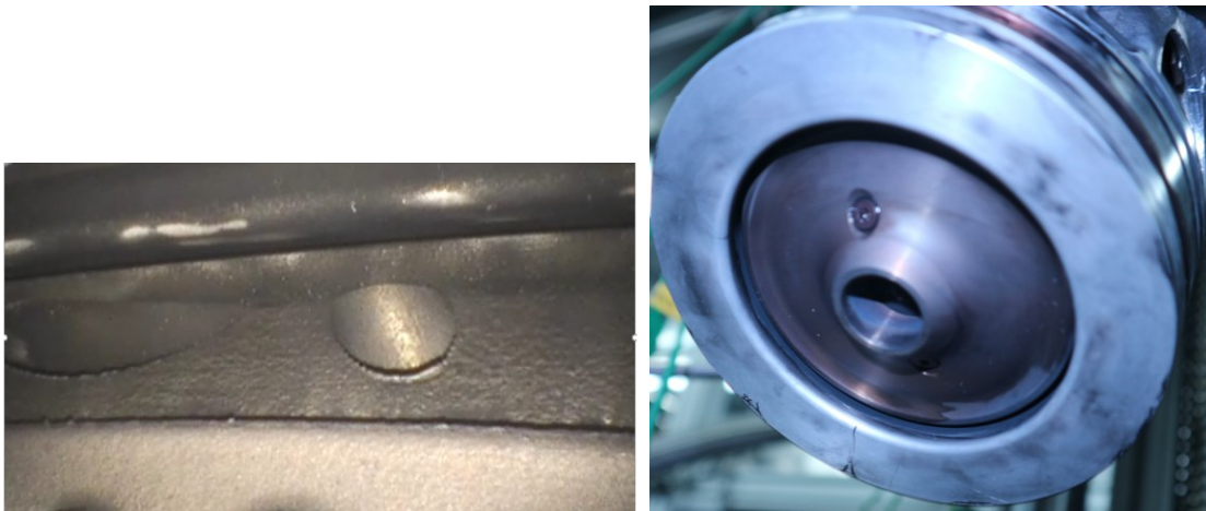
Abbildung 9.13: Muldenrand im montierten Zustand auf der linken Seite und Kolben mit Prallteller auf der rechten Seite nach 7000 TMF-Zyklen und zusätzlichen 339 mit HCF-Last überlagerten TMF-Zyklen
