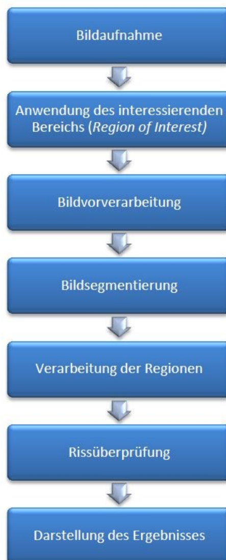
Abbildung 5.11: Ablauf nach [94] beim Schwellenwertverfahren und der Morphologie [95]
