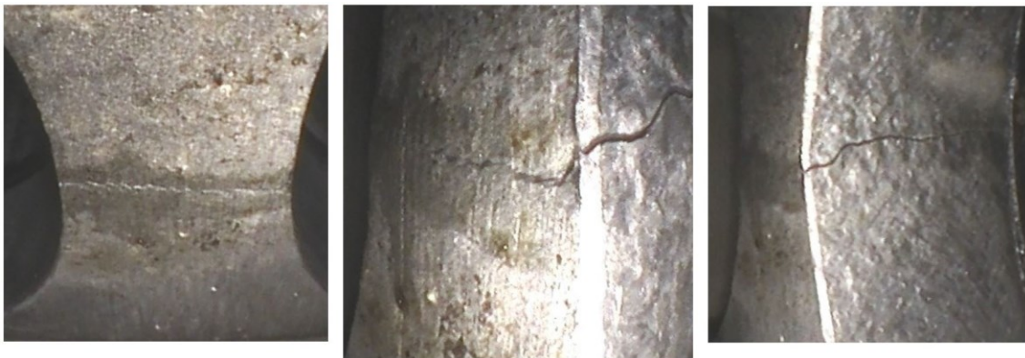
Abbildung 9.7: Stegbereich im eingebauten Zustand nach der TMF/HCF-Prüfung mit F_{a,HCF} = 3,92 kN und überarbeitetem Kühladapter
