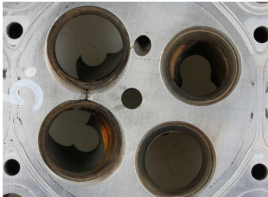
Abbildung 2.2: Schadensbild an dem Brennraumdach eines Zylinderkopfes [13]
