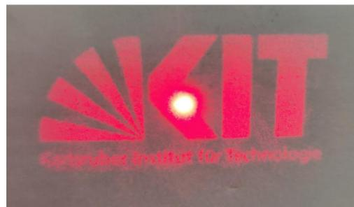
(d) Foto des Ergebnisses einer transversalen Strahlmodulation des roten 638 nm Dauerstrich-Testlasers mit deutlich erkennbarer nullter Ordnung in der Mitte.
