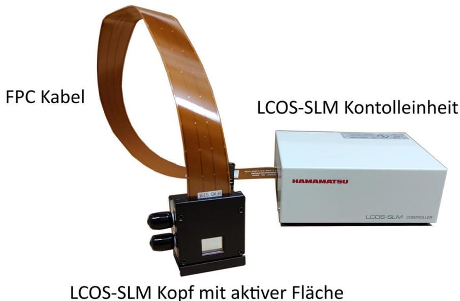
**Abbildung 2.7.:** Foto des verwendeten Hamamatsu X15213-02 LCoS-SLMs der für die Versuche mit dem 800 nm FLUTE Laser in Kapitel 3.3.1, 3.3.2 und die longitudinalen Pulsformungsexperimente in Kapitel 4 verwendet wurde.
