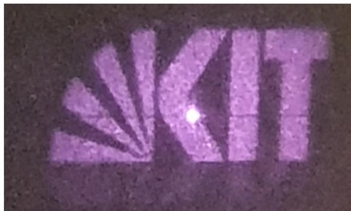
**Abbildung 3.8.:** Foto des Ergebnisses einer transversalen Strahlmodulation des gepulsten 800 nm FLUTE Lasers mit deutlich erkennbarer nullter Ordnung. Die horizontale dunkle Linie ist auf einen Berechnungsfehler innerhalb der Hologrammerzeugung zurückzuführen und bereits behoben. Das Bild wurde mit einer gebräuchlichen Kamera aufgezeichnet, die im infraroten Bereich sensitiv ist.
