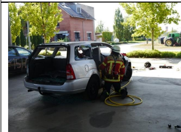
Abbildung 31: Arbeiten mit dem Rettungszylinder - Versuchsfahrzeug 1
