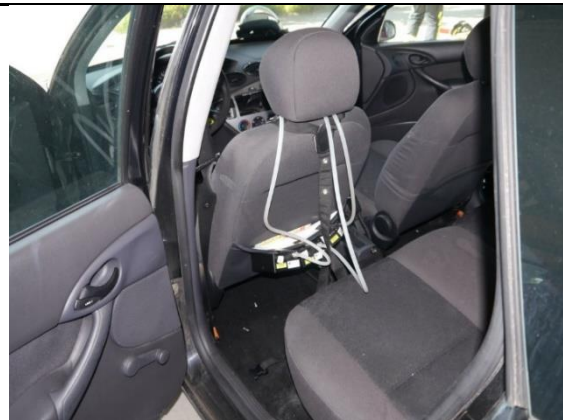
Abbildung 15: Fahrersitz ohne Übungs- puppe mit Staub- und Fasermesstech- nik, Versuchsfahrzeug 2 - Rückseite
