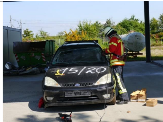
Abbildung 37: Arbeiten mit der Säbelsäge - Versuchsfahrzeug 2
