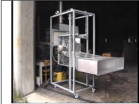
Abbildung 1: Radialgebläse zur Winderzeugung: 3 m/s [Kunkelmann, J. /2007/]
