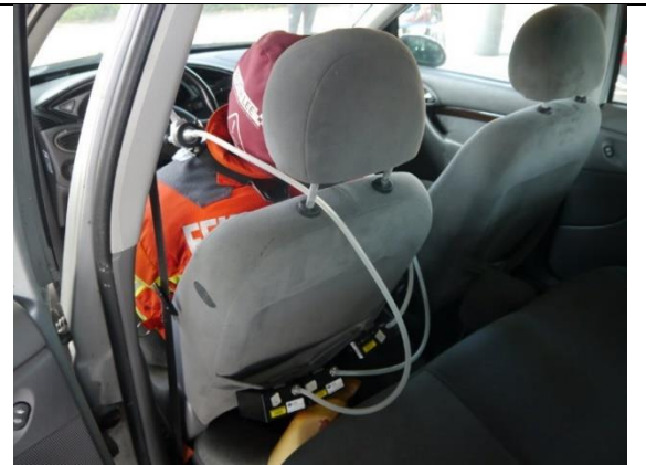
Abbildung 9: Dummy - Übungspuppe als Patient mit Staub- und Fasermesstechnik vor dem Abdecken mit Patientenschutzfolie, Versuchsfahrzeug 1 - Rückseite
