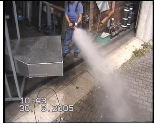
Abbildung 2: Kaltsprühversuch mit Hochdruck-Wassernebel - Einzeldüse – 135 bar Ablenkung durch Wind (3 m/s) [Kunkelmann, J. /2007/]
