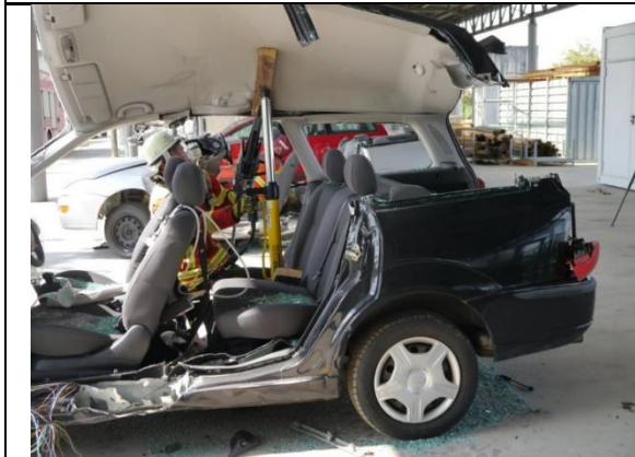
Abbildung 44: Arbeiten mit dem Rettungszyylinder - Versuchsfahrzeug 2
