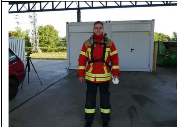
Abbildung 10: Feuerwehrangehöriger (Angriffstrupp) mit Staub- und Fasermesstechnik – Vorderseite (LFS-BW)
