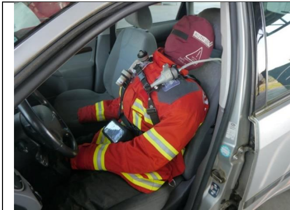
Abbildung 8: Dummy - Übungspuppe als Patient mit Staub- und Fasermesstechnik vor dem Abdecken mit Patientenschutzfolie, Versuchsfahrzeug 1 - Vorderseite
