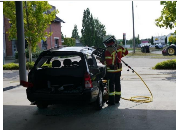
Abbildung 41: Arbeiten mit dem hydraulischen Spreizer - Versuchsfahrzeug 2
