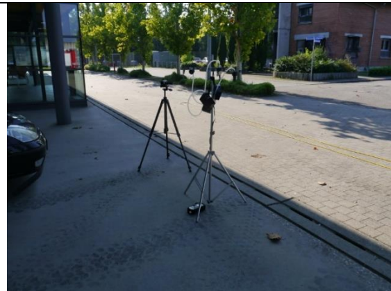
Abbildung 13: Dummy (Stativ) als Er- satz für Gruppenführer mit Staub- und Faser- messtechnik sowie Videokamera
