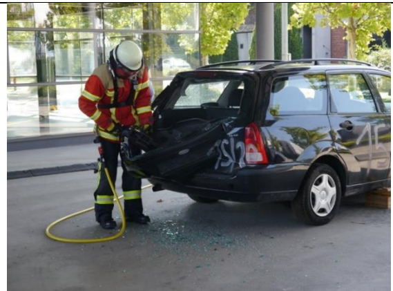
Abbildung 39: Arbeiten mit dem hydraulischen Spreizer - Versuchsfahrzeug 2
