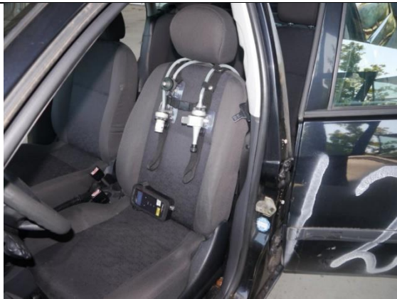
Abbildung 34: Fahrersitz ohne Übungspuppe mit Staub- und Fasermesstechnik, Versuchsfahrzeug 2 - Vorderseite
