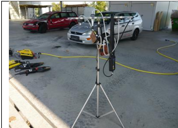
Abbildung 12: Dummy (Stativ) als Ersatz für Gruppenführer mit Staub- und Faser- messtechnik
