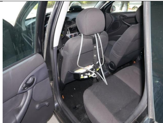
Abbildung 35: Fahrersitz ohne Übungspuppe mit Staub- und Fasermesstechnik, Versuchsfahrzeug 2 - Rückseite
