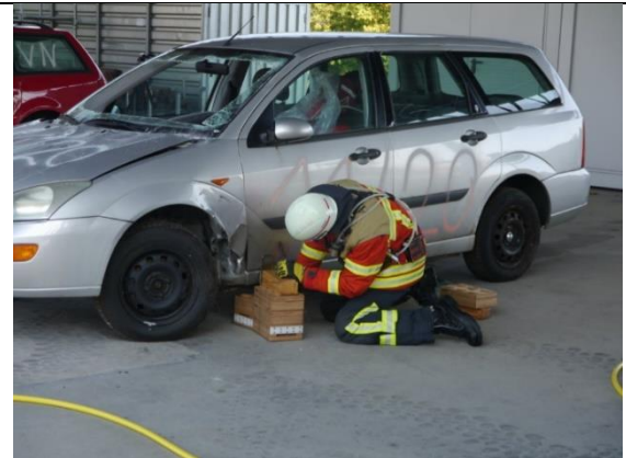
Abbildung 24: Stabilisierung des Unfallfahrzeuges - Versuchsfahrzeug 1
