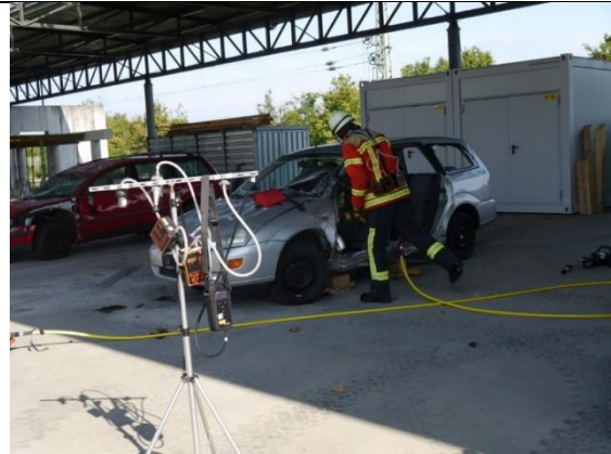
Abbildung 26: Arbeiten mit der hydraulischen Rettungsschere - Versuchsfahrzeug 1
