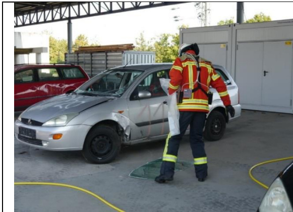
Abbildung 21: Übungspuppe mit Staub- und Fasermesstechnik, Abdecken mit Patientenschutzfolie, Versuchsfahrzeug 1
