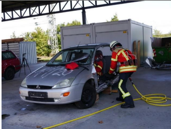
Abbildung 25: Arbeiten mit dem hydraulischen Spreizer - Versuchsfahrzeug 1
