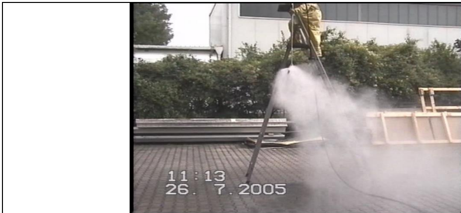
Abbildung 3: Kaltsprühversuch mit Hochdruck-Wassernebel – Sprühkopf mit 4 Düsen – 135 bar, Ablenkung des Sprühnebels durch Wind im Freien [Kunkelmann, J. /2007/]
