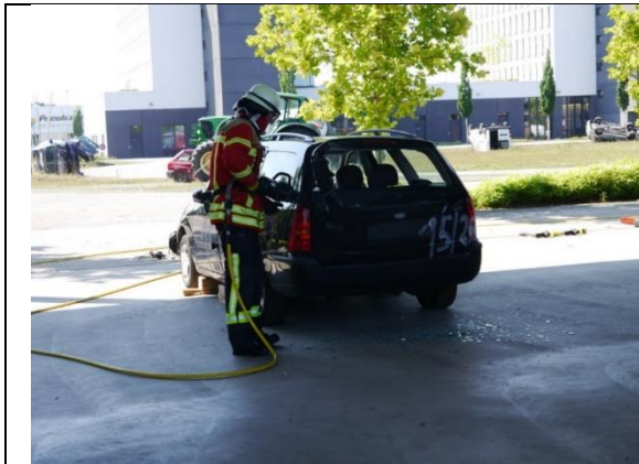
Abbildung 38: Arbeiten mit dem hydraulischen Spreizer - Versuchsfahrzeug 2
