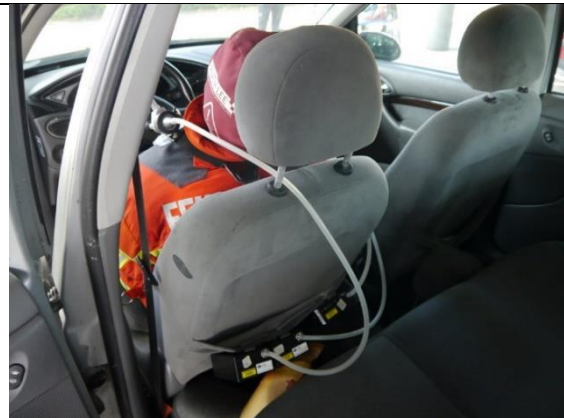
Abbildung 20: Übungspuppe mit Staub- und Fasermesstechnik vor dem Abdecken mit Patientenschutzfolie, Versuchsfahrzeug 1 - Rückseite
