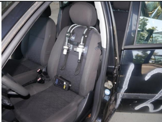
Abbildung 14: Fahrersitz ohne Übungs- puppe mit Staub- und Fasermesstech- nik, Versuchsfahrzeug 2 - Vorderseite
