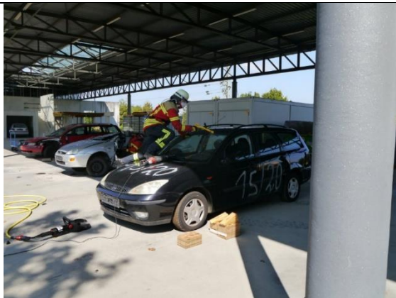
Abbildung 36: Arbeiten mit dem Glas-Master - Versuchsfahrzeug 2
