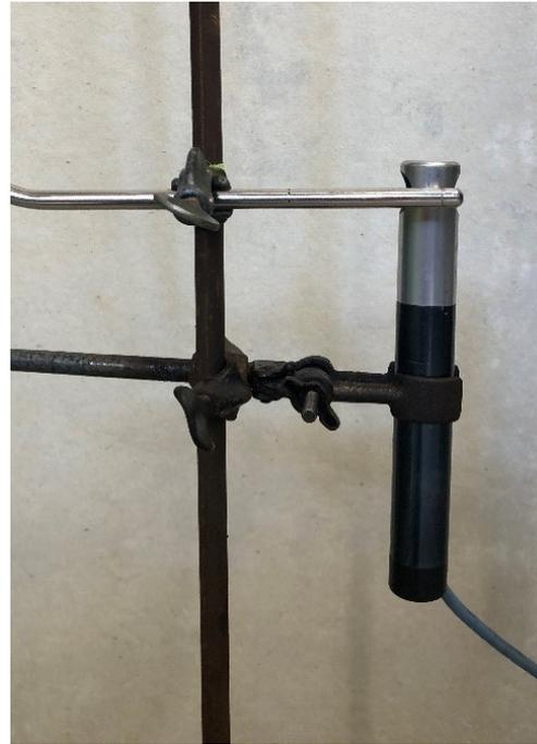
Abb. 11: Seitenansicht Messstelle Strömungsgeschwindigkeit
