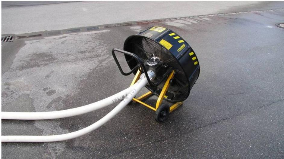
Abb. 5: Wasserbetriebener Lüfter (Freiwillige Feuerwehr Tuttlingen: Überdrucklüfter 2020)
