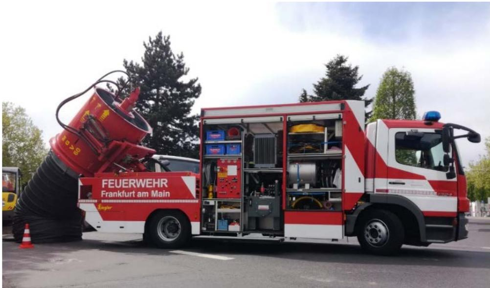
Abb. 2: Mobiler Großventilator der Branddirektion Frankfurt am Main im nach hinten abgekippten Betriebszustand mit angeschlossener Lutte
