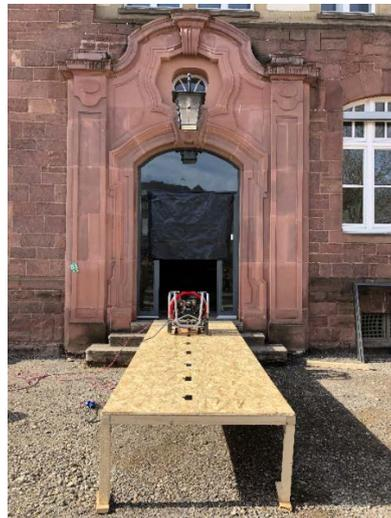
Abb. 51: Lüfter vor teilweise abgedeckter Türöffnung (H=105cm x B=97cm)
