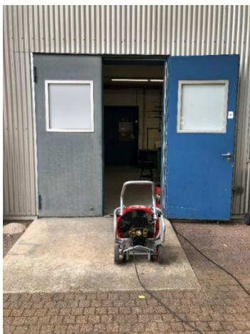
Abb. 38: 230V-Lüfter vor vollflächig geöffneter Zuluftöffnung
