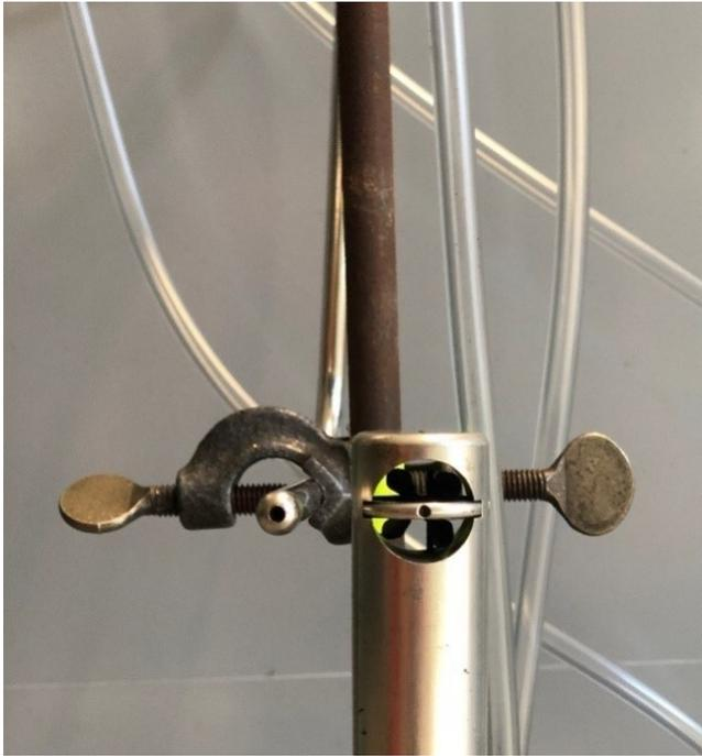
Abb. 10: Staudruckanemometern und Flügelrad-Anemometer
