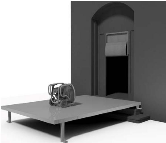
Abb. 50: Lüfter vor teilweise abgedeckter Türöffnung CAD
