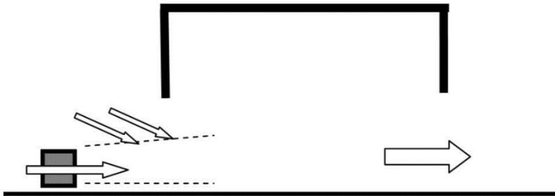
Abb. 6: Injektorlüfter mit geringer Strahlaufweitung (Reick, 2015)
