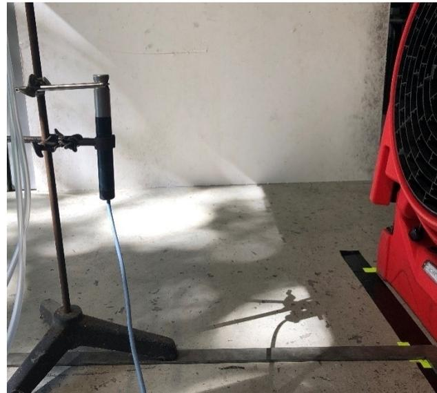
Abb. 13: Versuchsaufbau Bestimmung Strömungsgeschwindigkeit
