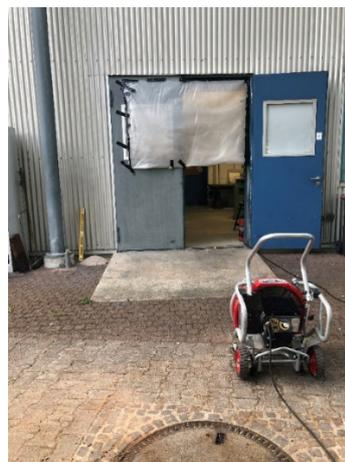
Abb. 39: 230V-Lüfter im Abstand von 2m vor halb verschlossener Zuluftöffnung
