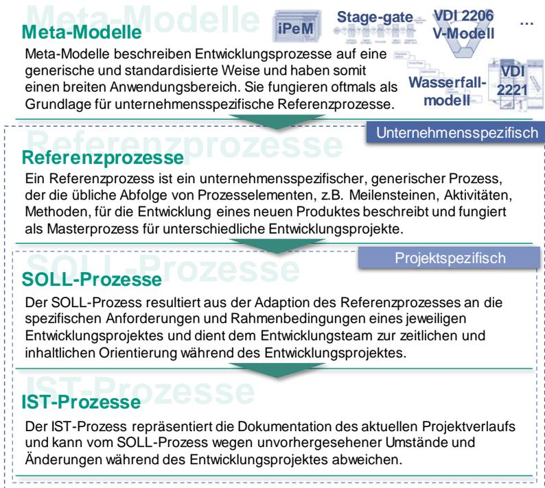
Abbildung 2.5: Unterschiedliche Prozesstypen in der Produktentwicklung nach WILMSEN et al. (2020) basierend auf VDI 2221 (2019a) und ALBERS et al. (2016c)
