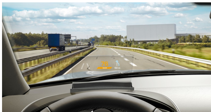
Abbildung 2.1: Informationsdarstellung eines Combiner Head-Up-Displays [PS16]
