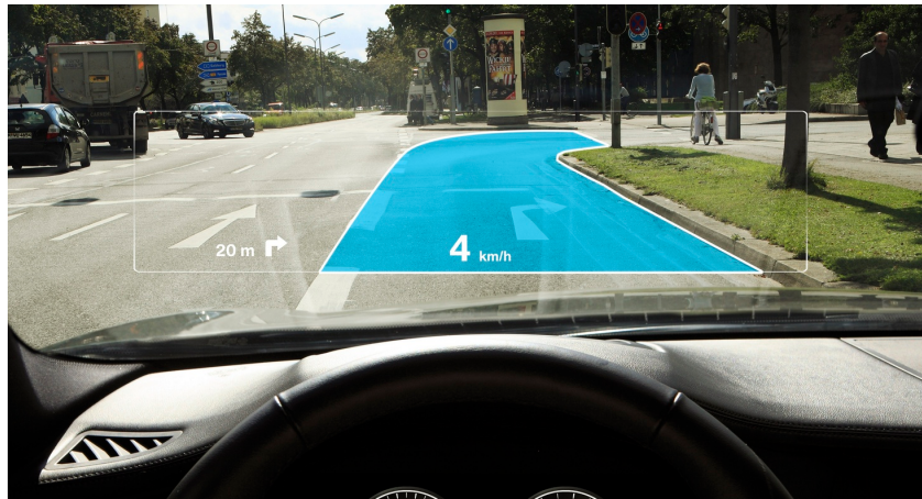
Abbildung 2.8: Ortskorrekte Darstellung eines Navigationshinweises durch ein Augmented Reality Head-Up-Display [GFK14]
