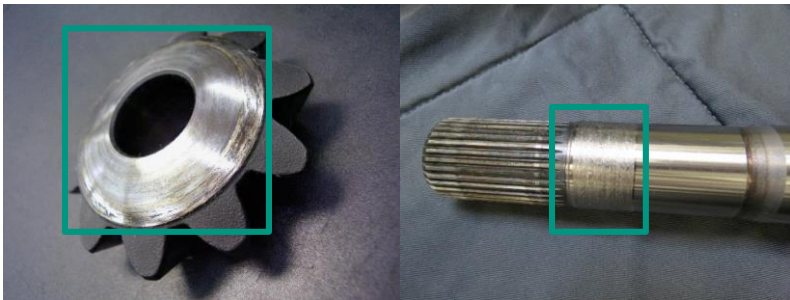
Abbildung 2.11: Beispiele für Fressen an einem Ausgleichskegelrad (links) und einer Antriebswelle (rechts). Bildquelle: DR. ING. H.C. F. PORSCHE AG
