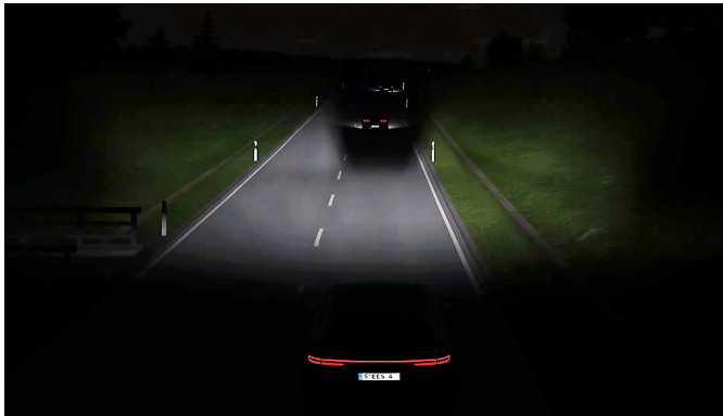
Abbildung 3.9.: Visualisierung einer Ausblendsituation mit einem 84-Pixel Matrix-Beam-Scheinwerfersystem eines Porsche Cayenne (Typ E3) mit dem Light-Source-Combiner in der Umfeldsimulation VTD
