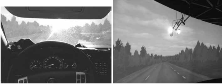
Abbildung 3.4.: Blendung durch tiefstehende Sonne im Fahrsimulator aus Fahrersicht (links) mit vor dem Fahrsimulatorschirm angebrachter Halogenlampe (rechts) [54] 6
