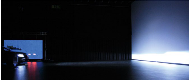
Abbildung 3.7.: Stimulation der Fahrerassistentenkamera in einem ViL-Testsystem über eine LED-Videoleinwand in einer Lichtmesshalle [64]
