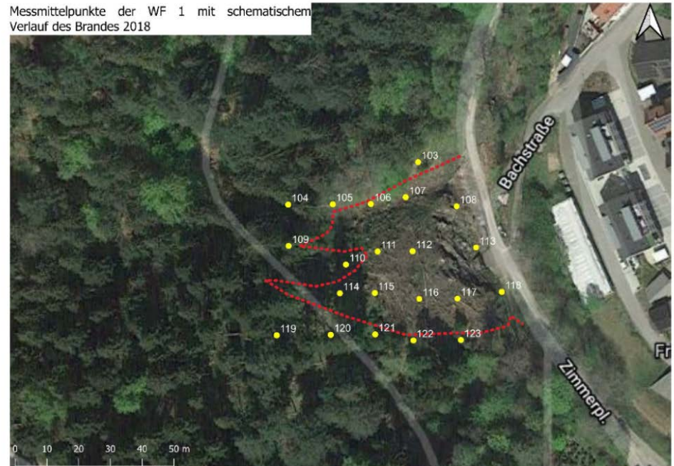
Abbildung 9: Erhobene Messmittelpunkte WF 1 und schematischer Brandverlauf (eigene Darstellung 2021)
