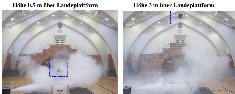
Abbildung 4.6: Testflüge in schlechten Sichtbedingungen bei einer Höhe von 0,5 m (links) und 3 m (rechts). Die Flugplattform ist mit der gestrichelten Box markiert.
