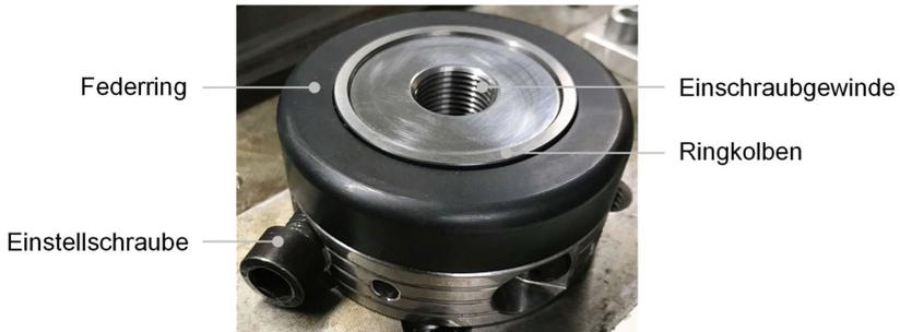
Abbildung 5-5: Eingesetzte Hydrodehnspannmutter zur Aufbringung der Axialkraft
