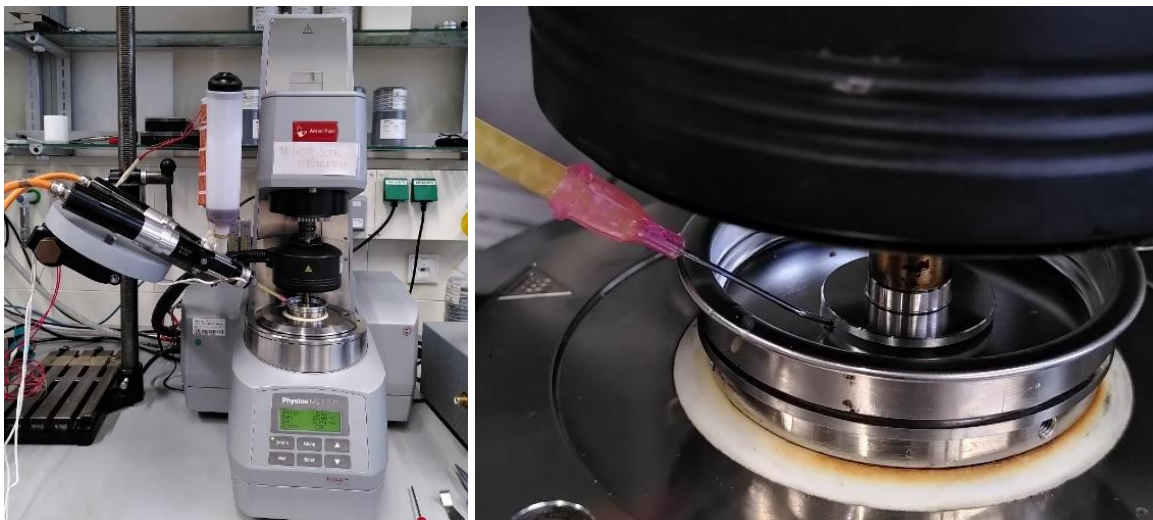
Abbildung 3.3: Links: Gesamter Versuchsaufbau für die Rheologiemessungen mit automatisiert dosiertem Harzsystem; rechts: Detailaufnahme der Positionierung des Statikmischers mit Injektionsnadel
