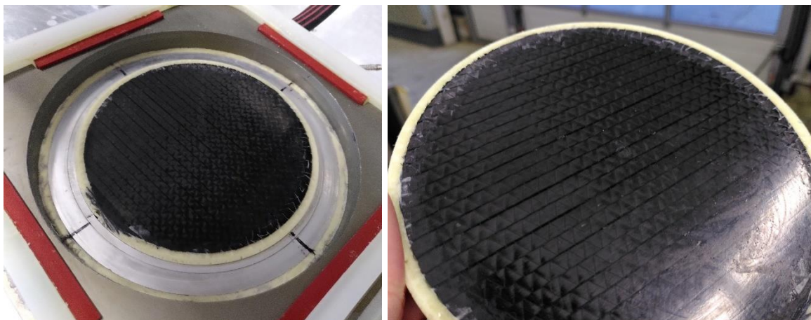
Abbildung 4.2: Bauteilbilder von Sandwichstrukturen aus dem D-SCM Prozess; links: Im Unterwerkzeug nach der Werkzeugöffnung; rechts: Entformtes, ausgehärtetes Sandwichbauteil
