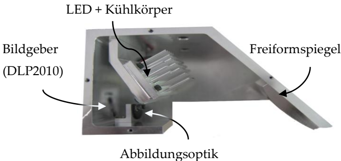
Abbildung 7.13: Draufsicht auf den Prototypen. Das Strahlenbündel tritt durch die Öffnung auf der Abbildung unten aus dem System aus.
