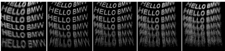
Abbildung 7.10: Abbildungsqualität auf der Projektionsebene mit unterschiedlicher Distanz der Projektionsoptik zum Bildgeber. Die Abstandsvariation zwischen den einzelnen Bildern beträgt 0,3 mm.
