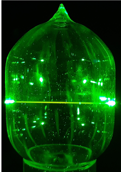
Abbildung 8.2: Fluoreszenz von molekularem I_2 -Dampf bei Anregung mittels 532 nm Laserstrahlung
