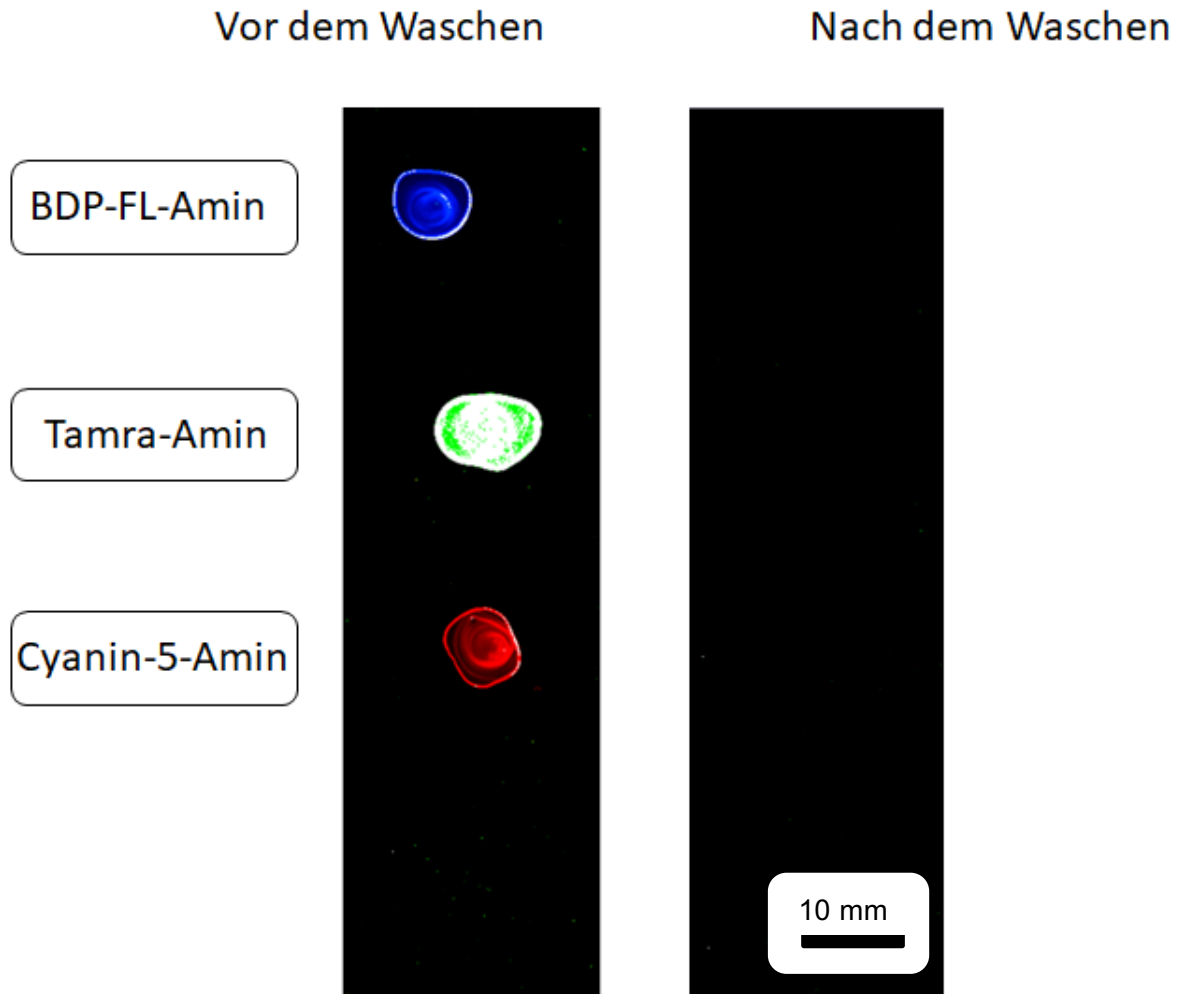
Abbildung 48: Fluoreszenzaufnahme von drei Fluorophoren in allen drei Kanälen, Blau: DBP-FL-Amin, Grün: TAMRA-Amin und Rot: Cyanin 5-Amin; Aufnahmeparameter: Anregungswellenlänge: 488 nm, Filter: 504/12 nm; Anregungswellenlänge: 532 nm, Filter: 580/14 nm, Anregungswellenlänge: 635 nm, Filter: 677/45 nm; Auflösung: 5 \mu\text{m}
