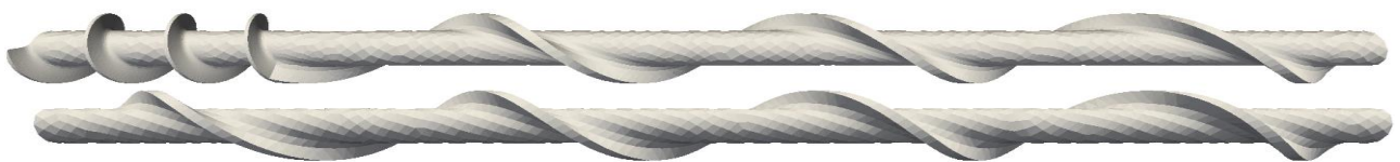
Abbildung 3.9: Schneckenengeometrien für die Zugabereihenfolge: 1. Biomasse 2. Wärmeträger (oben), 1. Wärmeträger 2. Biomasse (unten)
