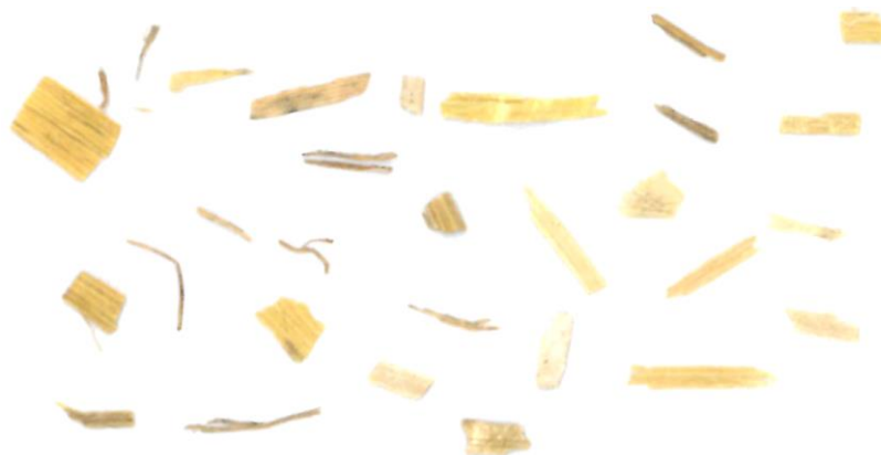
Abbildung 2.12: Auswahl der untersuchten Weizenstrohpartikel. Zweifach vergrößert.
