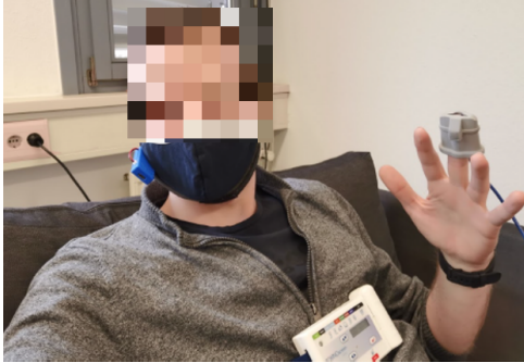
Abb. 8: Proband mit Polysomnographie System und am Ohr getragenen Sensor.
