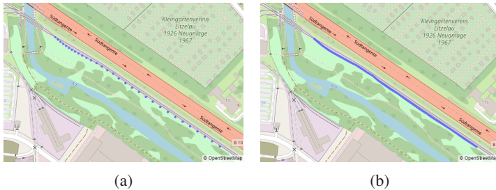
Abbildung 4.2: Auswirkung der Positionsinterpolation: (a) Rohdaten (1 Hz) (b) Interpolierte Positionen (10 Hz) (erstellt mit ©OpenStreetMap)
