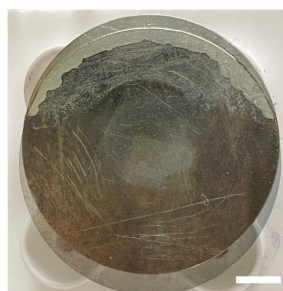
Abbildung 133: Probe mit besputterten Goldpartikeln (8,8 nm Dicke). Maßstabsbalken entspricht 5 mm.
