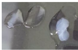
Abbildung 142: Polymerisierung des 2 mg/ml Kollagen I-Hydrogels in der Druckerkartusche. Nach einer 30-minütigen Polymerisierung des 2 mg/ml Kollagen I-Hydrogels entsteht ein inhomogen vernetztes nicht-druckbares Hydrogel.
