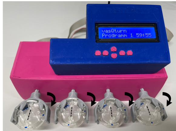
Abbildung 17: Darstellung des vasQturns zur Besiedlung des Mikrokanals der vasQchips. Um eine homogene Auskleidung der Zellen im Mikrokanal zu gewährleisten, rotiert der vasQchip um die eigene Achse (in Schwarz veranschaulicht) für 1 h mit der Drehzahl 0,25 rpm.
