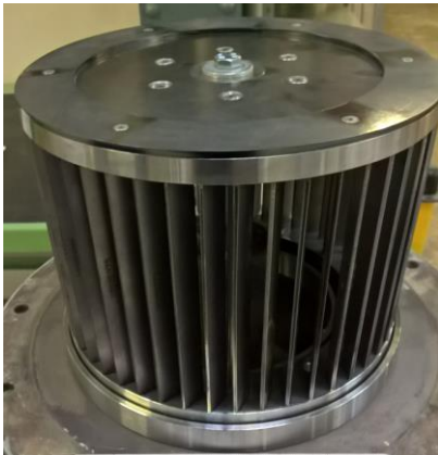
Abbildung 28: Sichtrad mit 48 radialen Schaufeln (links) und Skizze zum Anstellungswinkel der Schaufeln (rechts).
