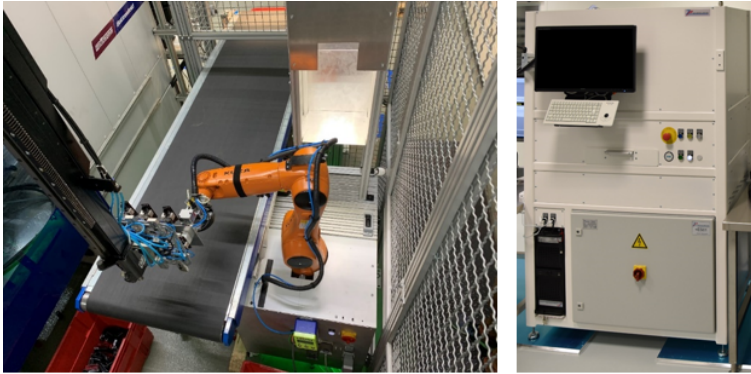
Abbildung 2: Bildaufnahmeeinrichtungen für die Prüfung von Makrobauteilen im Automobilbau (links) [2] und von mikrofluidischen Chips (rechts).
