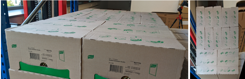
Abbildung 1: links: Originalaufnahme der Kamera, rechts: Auflösungsverlust durch Transformation in eine Draufsicht.
