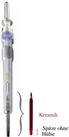
Abbildung 3.3 Durchsichtige Darstellung der Keramikglühkerze.
