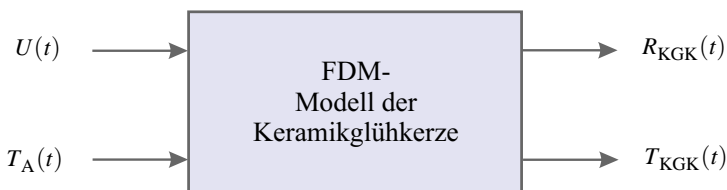
Abbildung 5.6 Vereinfachtes Glühkerzenmodell. U(t) : Spannung, T_A(t) : Temperatur in unmittelbarer Umgebung der Kerze, R_{KGK}(t) : Kerzenwiderstand sowie T_{KGK}(t) : Kerzentemperatur.
