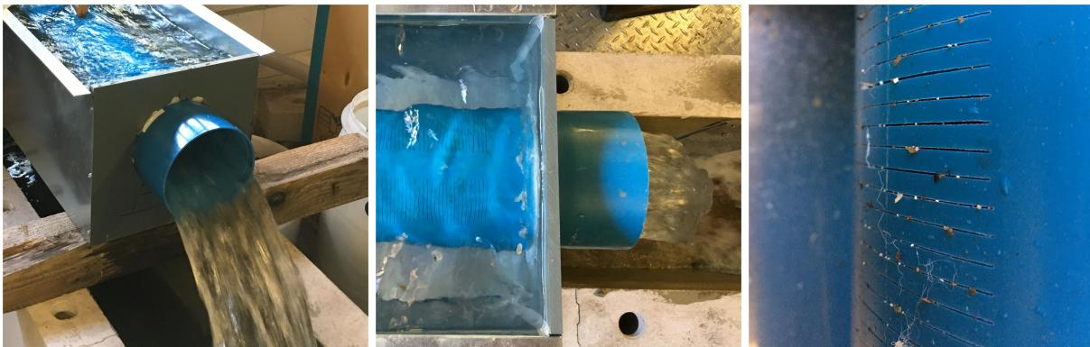
Abbildung 5.26: Modellversuch zur Bestimmung des Fassungsvermögens von Filterrohren im eingetauchten Zustand
