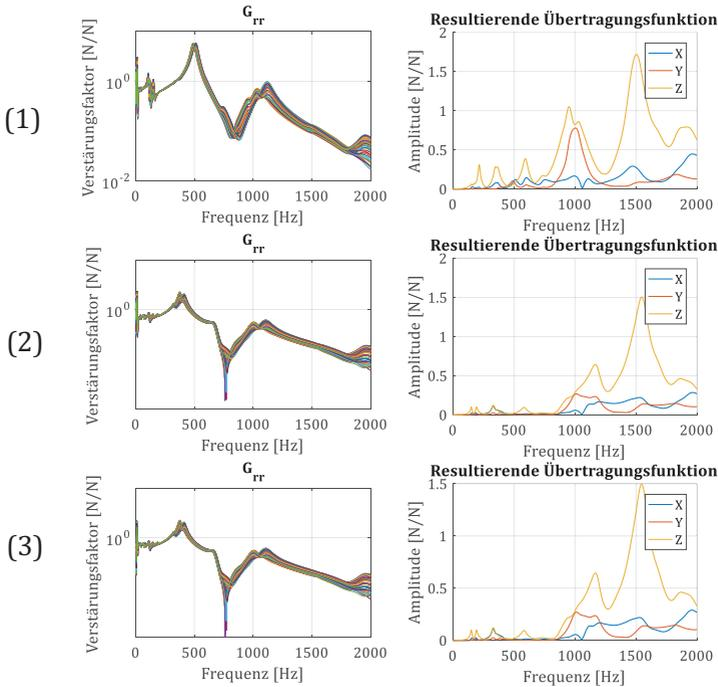
Abbildung 4.5: Darstellung der radialen Übertragungswege des Rotors auf das Radlager im Gesamtsystem und deren Einfluss auf der in Tabelle 4.1 dargestellten Randbedingungen
