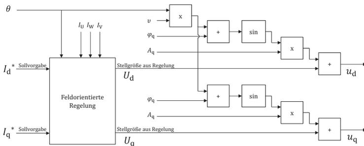
Abbildung 6.34: Aufgeprägte Schwingungen in der Spannung
