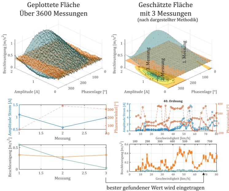
Abbildung 6.13: Darstellung der Vorgehensweise beim Suchen der Parameter und Vergleich mit den gemessenen und geschätzten Flächen (oben) an der Längslenkerbuchse in x-Richtung im Betriebspunkt 68 km/h der 40. Ordnung
