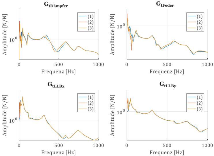
Abbildung 4.10: Abhängigkeit des tangentialen Übertragungsweges des Stators von den Randbedingungen
