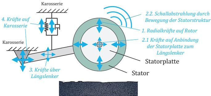
Abbildung 3.18: Übertragungsweg Stator radial
