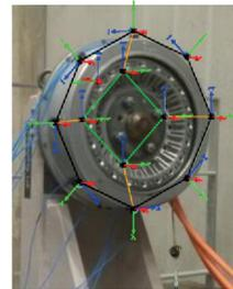
Abbildung 4.16: Vergleich der Eigenfrequenzen
