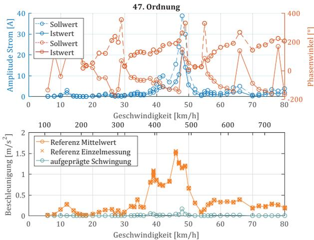
Abbildung 6.15: Parameter der HCI für Längslenkerbuchse (z) bei einer Kompensation mit  $I_q$  Strömen
