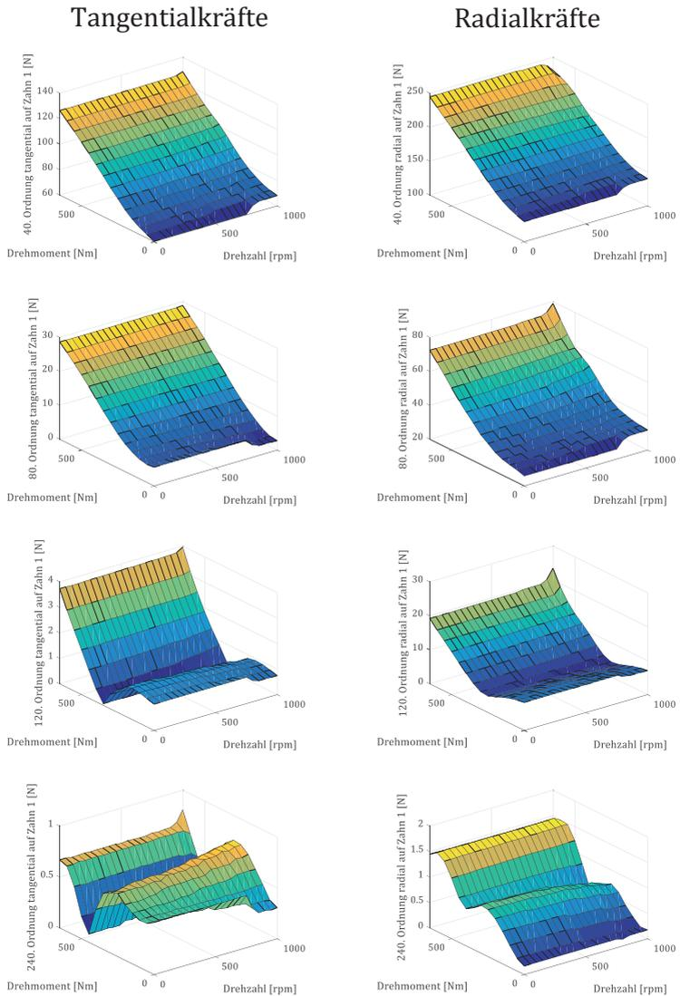
Abbildung 3.11: Übersicht der am stärksten ausgeprägten Ordnungen am Stator
