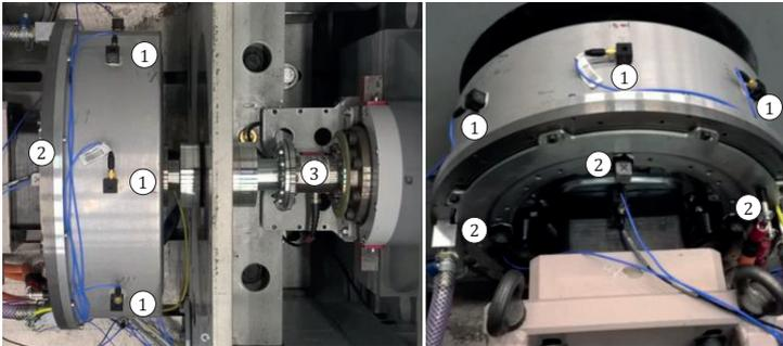
Abbildung 3.3: Versuchsaufbau zur Vermessung der elektrischen Maschine (1,2: Beschleunigungssensoren; 3: Drehmomentsensor)
