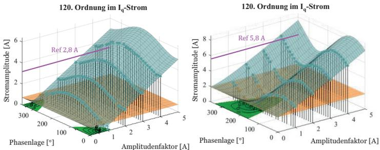
Abbildung 6.37: Einfluss der überlagerten Regelung auf die Ströme (links: 200 Nm, rechts: 400 Nm)
