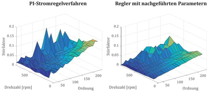
Abbildung 6.22: Vergleich des Störfaktors bei verschiedenen Regelverfahren bei 50 Nm
