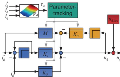
Abbildung 6.18: Struktur verschiedener Stromregelverfahren nach [Gem15]
