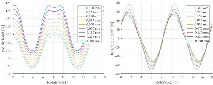
Abbildung 4.12: Darstellung der Kräfte über den Winkel auf einem Zahn bei geändertem Luftspalt, statische Exzentrizität, Betriebspunkt 100Nm/100rpm
