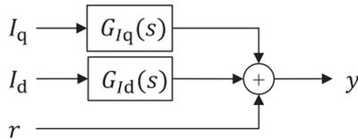
Abbildung 6.24: Modellvorstellung zur Trennung der Quellen ( $I_d$  und  $I_q$ )
