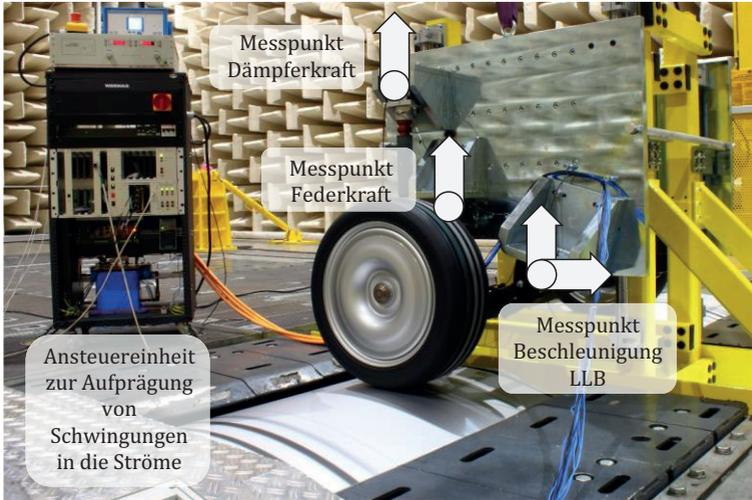
Abbildung 4.19: Aufbau für Messung der Übertragungswege
