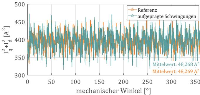
Abbildung 6.32: Quadratische Summe von  $I_q$  und  $I_d$  bei aufgeprägten Schwingungen
