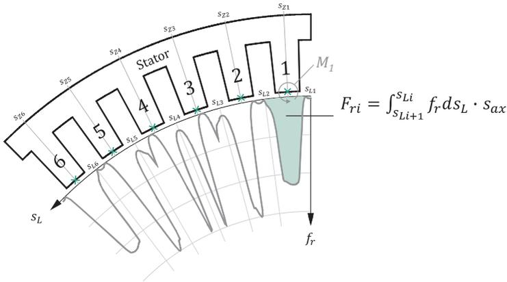
Abbildung 3.8: 2D-Darstellung der Kraftdichte im Luftspalt
