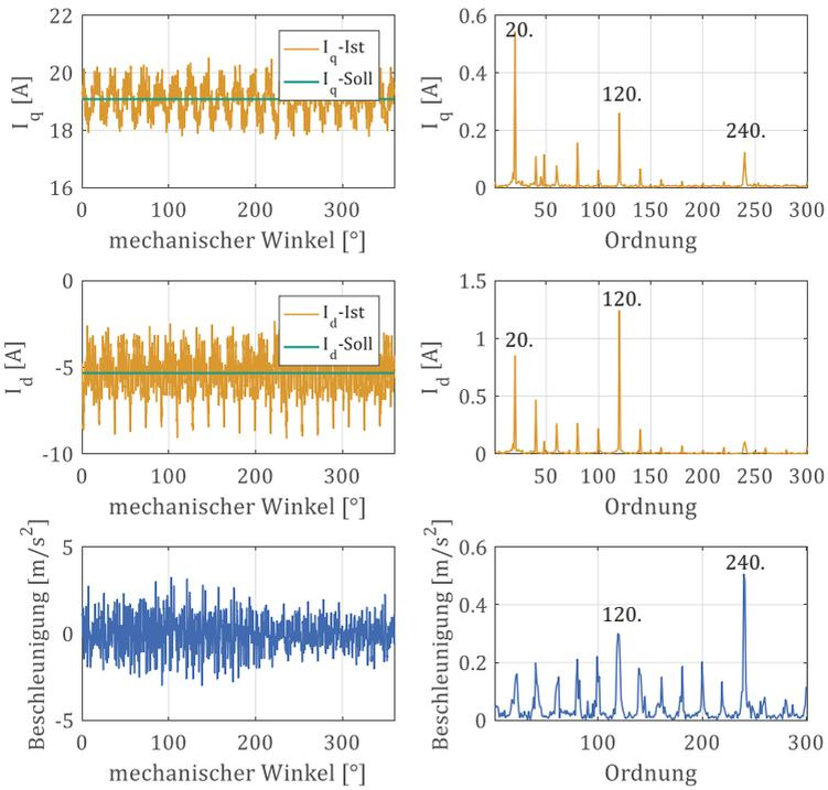
Abbildung 3.4: Oberschwingungen gleicher Ordnung in den Strömen und den Beschleunigungen (Statorplatte z-Richtung)
