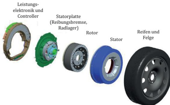
Abbildung 2.1: Aufbau des Radnabenantriebs
