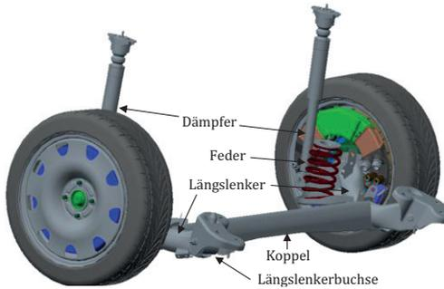
Abbildung 2.2: Aufbau des Gesamtsystems
