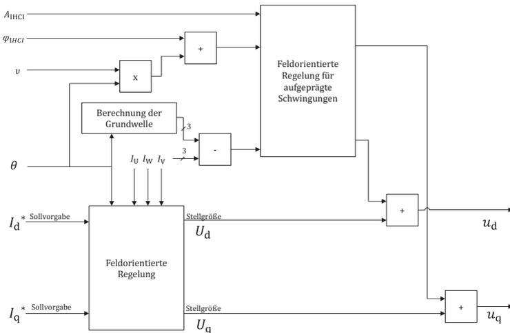
Abbildung 6.36: Aufgeprägte Schwingung in Strom durch überlagerte feldorientierte Regelung
