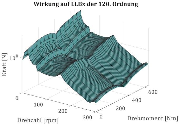
Abbildung 4.15: Wirkende Kräfte bei geänderten Betriebspunkten
