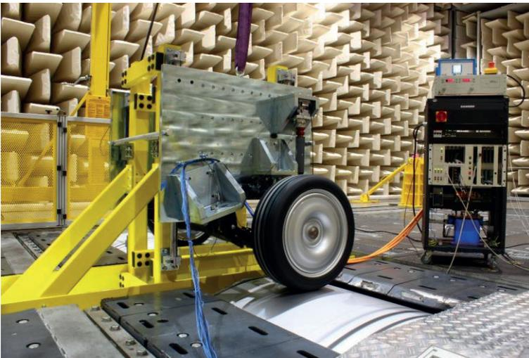
Abbildung 7.2: Aufbau des Prüfstandsadapters
