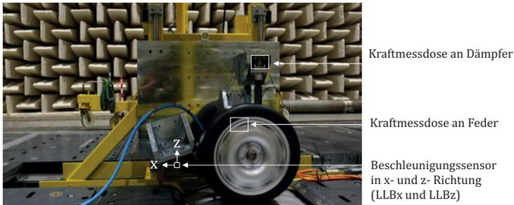
Abbildung 6.14: Lage der ausgewerteten Sensoren
