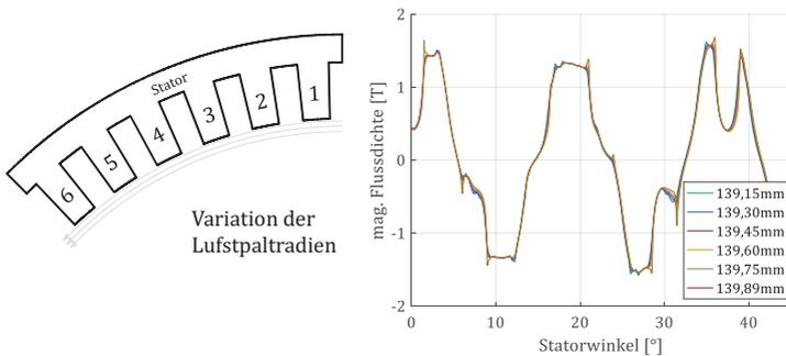
Abbildung 3.10: Einfluss des Radius auf die magnetische Flussdichte in radialer Richtung im Betriebspunkt 100 Nm/100rpm
