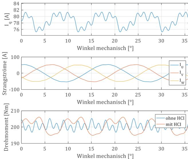
Abbildung 6.6: Ausgangsgrößen zu der Kompensation mehrerer Ordnungen
