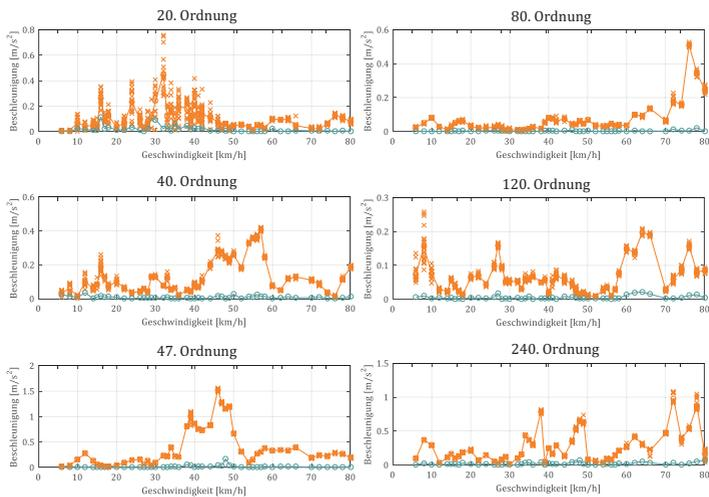
Abbildung 6.16: Übersicht des Potentials zur Kompensation an der Längslenkerbuchse (z)
