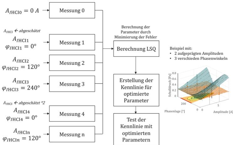
Abbildung 6.40: Ablauf Parameterberechnung im Gesamtfahrzeug
