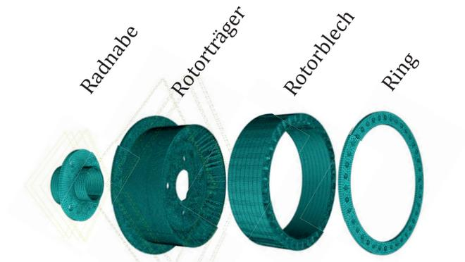
Abbildung 3.28: Aufbau Rotoreinheit
