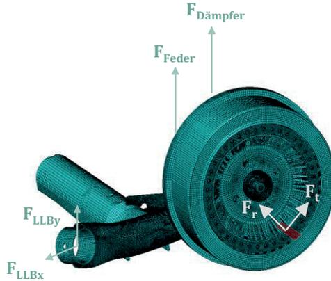
Abbildung 4.6: Veranschaulichung der zu den Übertragungsfunktionen gehörenden Anregungs- und Anbindungskräfte
