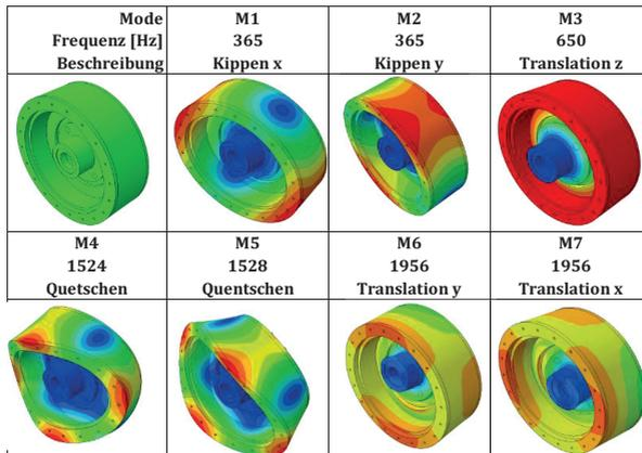
Abbildung 3.29: Modalanalyse Rotoreinheit
