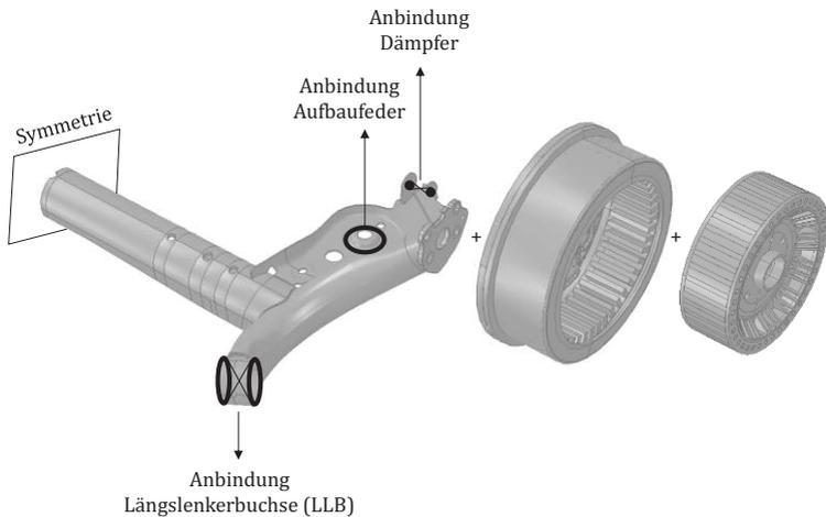
Abbildung 4.3: Mechanisches Modell
