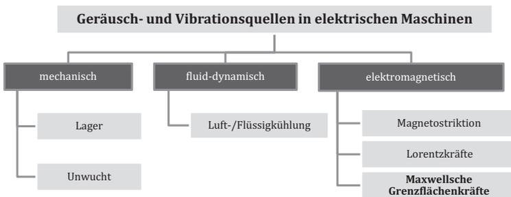
Abbildung 3.1: Übersicht möglicher Geräusch- und Vibrationsquellen in elektrischen Maschinen (in Anlehnung an [Vij98])
