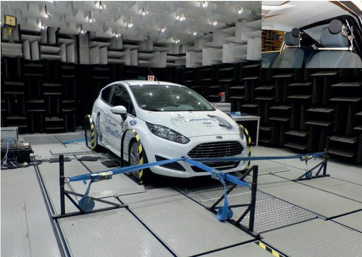
Abbildung 6.39: Akustischer Rollenprüfstand der Schaeffler Engineering GmbH
