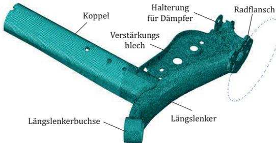
Abbildung 3.34: Aufbau Fahrwerk
