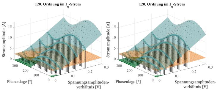
Abbildung 6.35: Einfluss der aufgeprägten Spannungsamplitude auf die Ströme (links: 200 Nm, rechts: 400 Nm)
