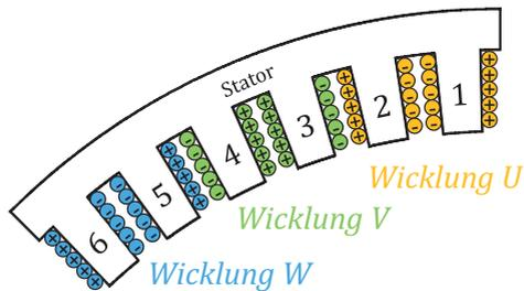
Abbildung 2.3: Wicklungsschema des Radnabenmotors
