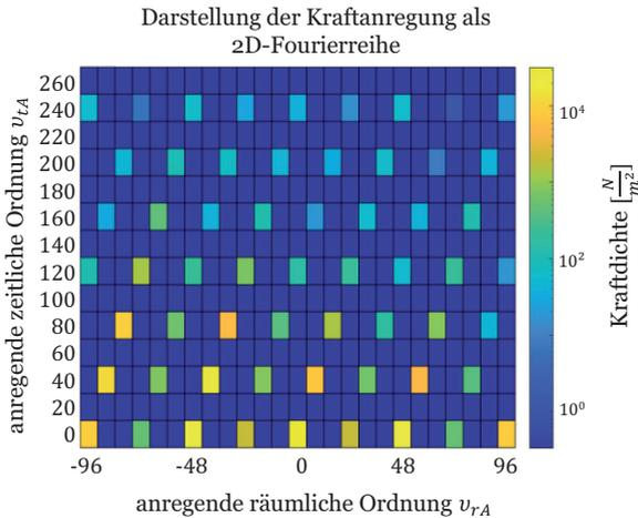
Abbildung 3.13: Darstellung der tangentialen Kraftanregung als 2D-Fourierreihe
