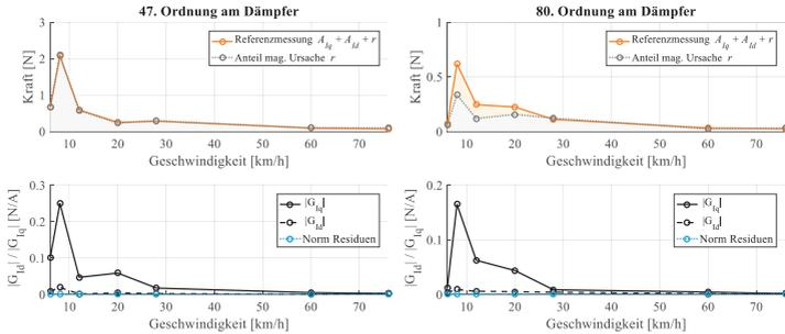
Abbildung 6.25: Trennung der Quellen an der Dämpferkraft ( $I_q$ ,  $I_d$ )
