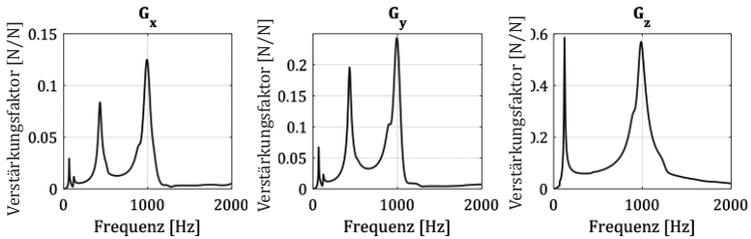
Abbildung 3.27: Resultierende Übertragungsfunktionen Stator
