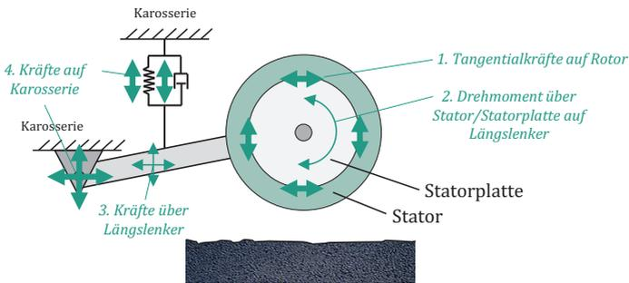
Abbildung 3.19: Übertragungsweg: Rotor tangential
