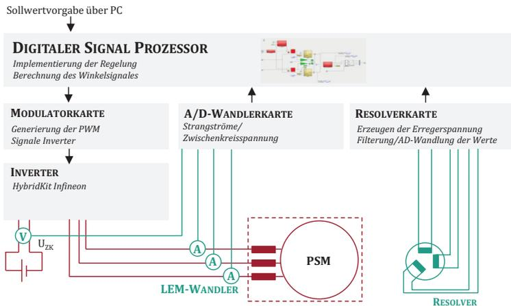
Abbildung 7.1: Aufbau der Ansteuereinheit
