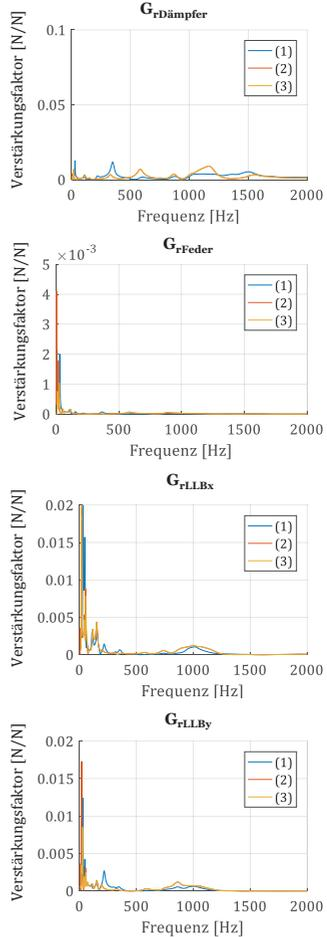
Abbildung 4.7: Resultierende Übertragungsfunktionen bei Variation der Randbedingungen
