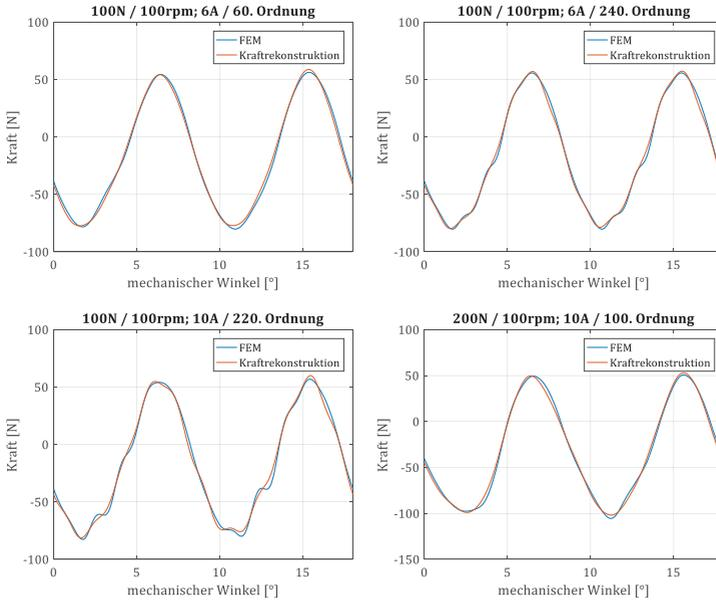
Abbildung 3.15: Darstellung der tangentialen Kräfte auf den 1. Zahn zum Vergleich der Kraftrekonstruktionsmethode mit der FEM bei verschiedenen Parametern
