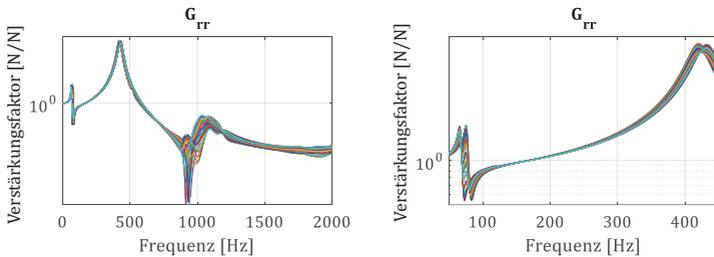
Abbildung 3.24: Radiale Übertragungswege (rotatorisch) Stator
