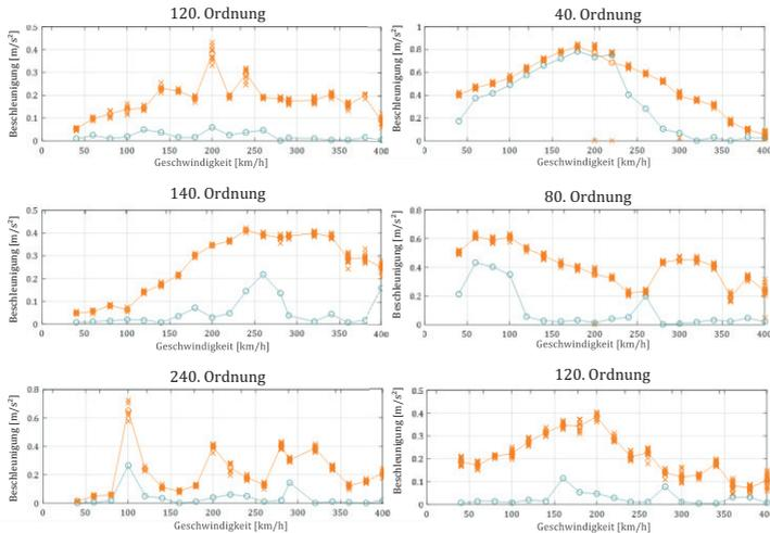
Abbildung 7.8: Kompensationspotential an Statorplatte und Statorgehäuse
