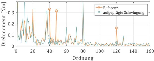
Abbildung 6.30: Kompensation des Drehmomentes bei 60 rpm mehrerer Ordnungen
