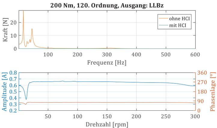
Abbildung 6.7: Kompensation 120. Ordnung (Dämpfer und LLBz)
