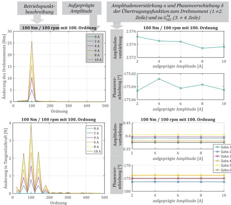
Abbildung 3.12: Abhängigkeit von Stromharmonischen in  $I_q$
