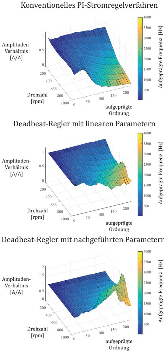
Abbildung 6.19: Vergleich der Regelverfahren
