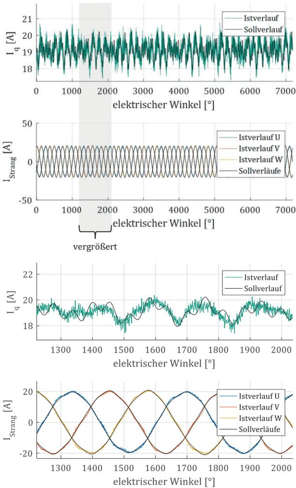
Abbildung 6.31: Ströme zur Kompensation des Drehmoments
