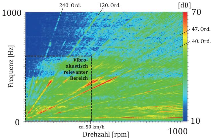
Abbildung 1.2: Schalldruckpegel im Fahrzeuginnenraum am Akustikrollenprüfstand (A-bewertet)
