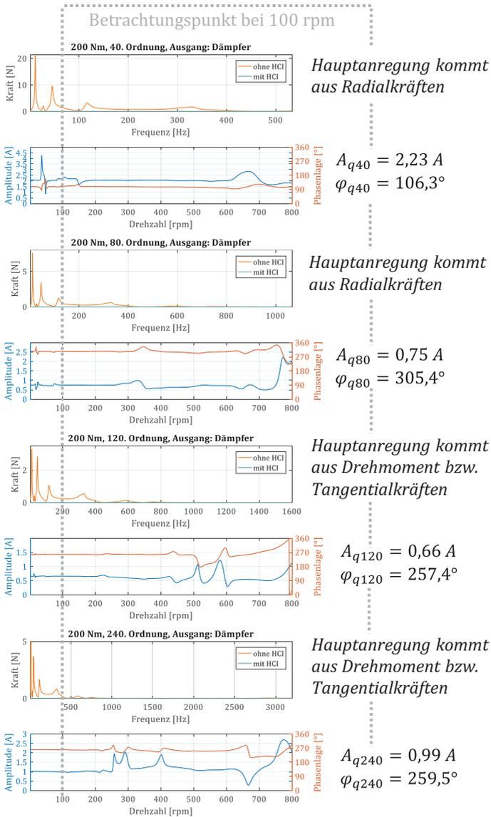
Abbildung 6.5: Kompensation am Dämpfer wirkenden Kräfte mehrerer Ordnungen
