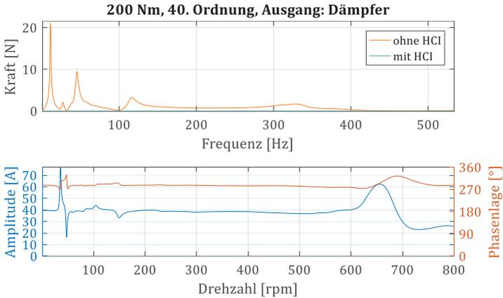
Abbildung 6.4: Kompensation der am Dämpfer wirkenden Kräfte zur Karosserie mit dessen Kompensationsparameter für  $I_d$
