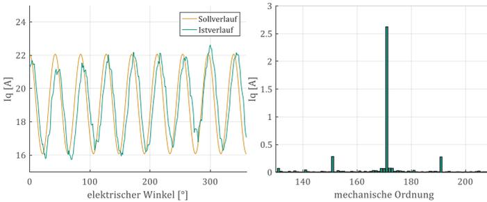
Abbildung 6.21: Aufprägung der 170. Ordnung mit 3 A beim Betriebspunkt 100rpm/50Nm mit dem PI-Stromregelverfahren
