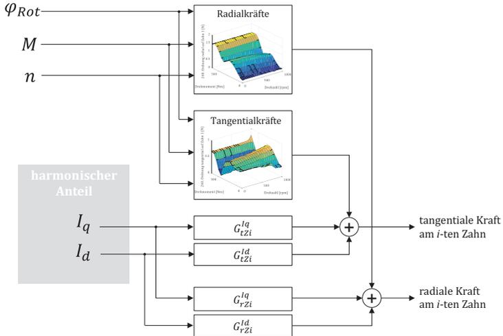
Abbildung 3.9: Aufbau des elektromagnetischen Modells zur Berechnung der wirkenden Kräfte auf Statorzähne
