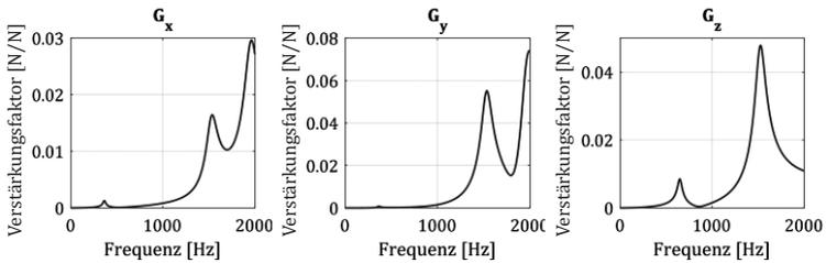
Abbildung 3.32: Gesamt resultierende Übertragungsfunktionen des Rotors
