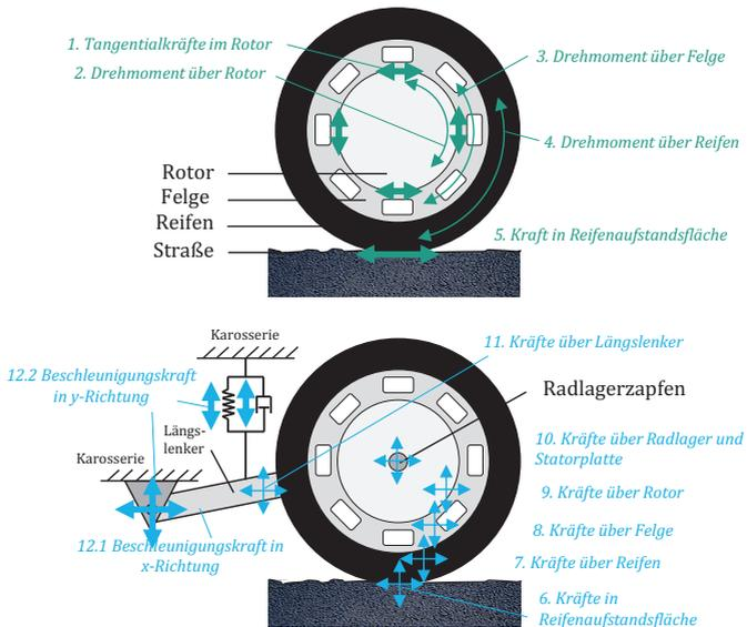
Abbildung 3.17: Übertragungsweg Rotor tangential
