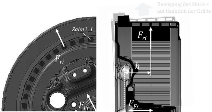
Abbildung 3.26: Skizze radial wirkende Kräfte auf Stator
