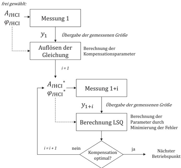
Abbildung 6.11: Ablauf für Parametersuche
