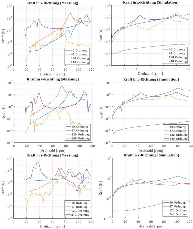
Abbildung 4.18: Vergleich der wirkenden Kräfte zwischen Simulation und Messung
