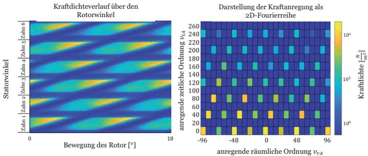
Abbildung 3.6: Darstellung der Kraftdichteanregung bei 400 Nm
