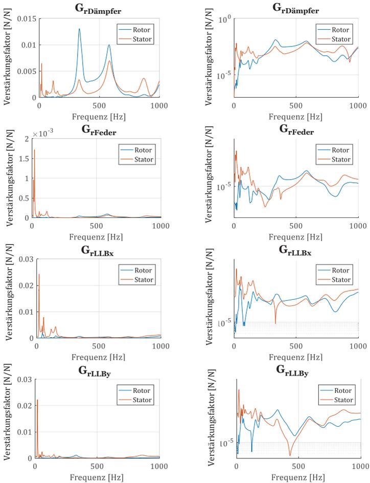
Abbildung 4.9: Vergleich der Übertragungswege mit radialen Anregungskräften
