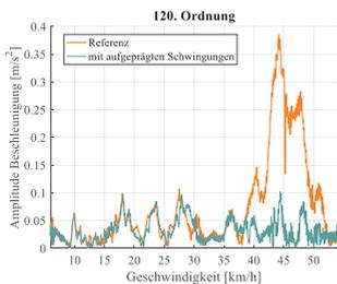
Abbildung 6.33: Kompensationsvorgang Beschleunigung LLB (x)
