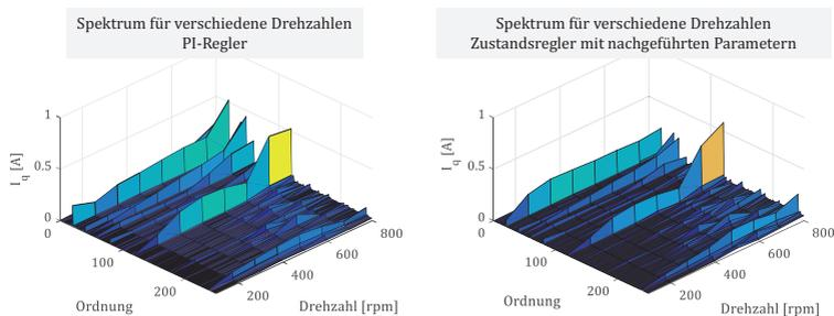
Abbildung 6.23: Vergleich der Stromüberschwingungen
