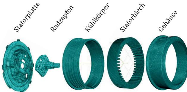
Abbildung 3.20: Aufbau Statoreinheit
