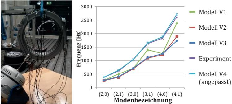
Abbildung 3.21: Vergleich der berechneten mit den experimentell bestimmten Frequenzen [Mal14]
