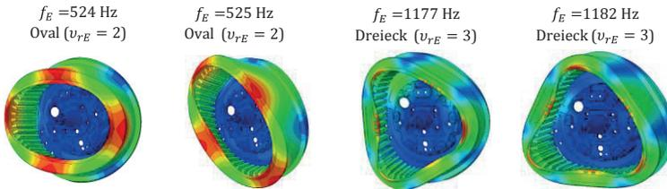
Abbildung 3.7: Relevante Strukturmoden für Radialkraftdichte
