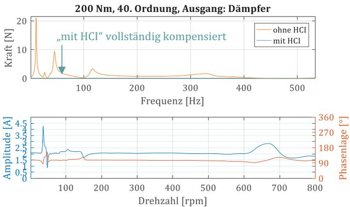
Abbildung 6.3: Kompensation der am Dämpfer wirkenden Kräfte zur Karosserie mit dessen Kompensationsparameter für  $I_q$
