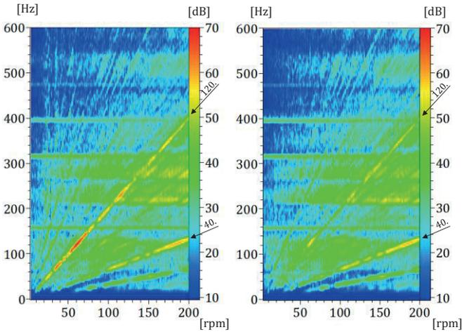
Abbildung 6.45: Schalldruck rechter E-WD ohne (links) und mit (rechts) HCI bei 400 Nm – 120. Ordnung
