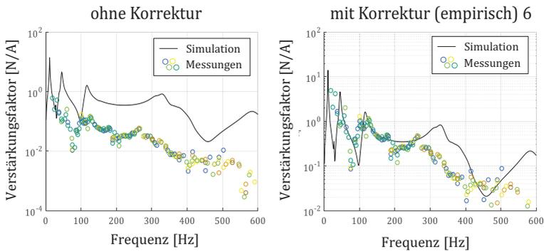
Abbildung 4.24: Vergleich der Übertragungsfunktionen zum Dämpfer
