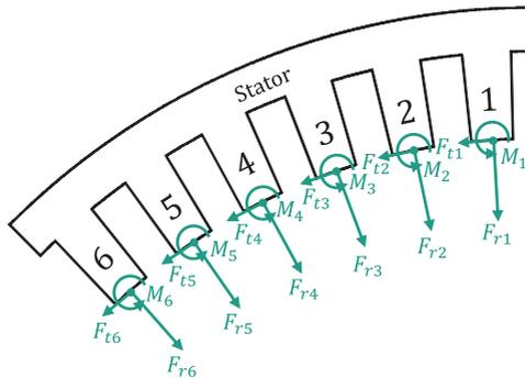
Abbildung 3.5: Veranschaulichung der radialen und tangentialen Kräfte und Momente, die auf die Statorzähne wirken
