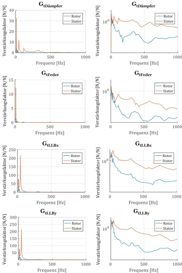
Abbildung 4.8: Vergleich der Übertragungswege mit tangentialen Anregungskräften
