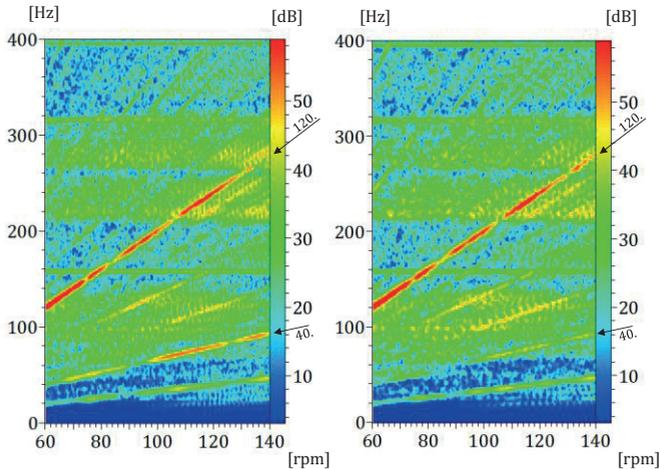
Abbildung 6.46: Schalldruck rechter E-WD mit/ohne HCI bei 400 rpm – 40. Ordnung
