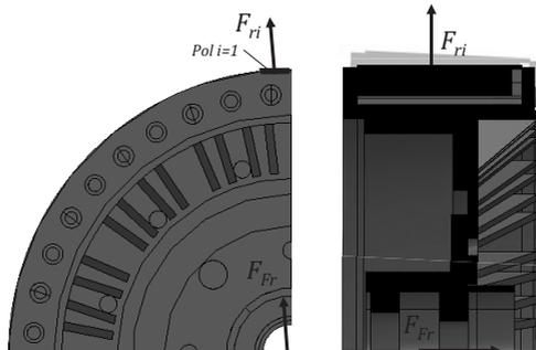
Abbildung 3.33: Skizze radial wirkender Kräfte auf Rotor
