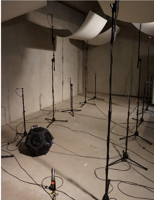
Abbildung 5.24: Messaufbau im Hallraum der HsKA nach DIN EN ISO 3741
