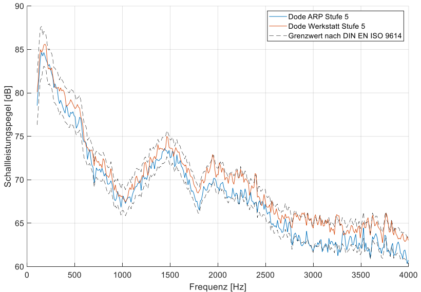
Abbildung 5.14: Vergleich der Schalleistungspegel im reflexionsarmen Prüfstand und in einem Raum ohne akustische Maßnahmen
