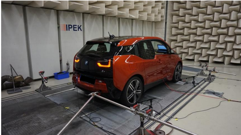
Abbildung 5.29: Messaufbau an einem Elektrofahrzeug auf dem Akustikrollenprüfstand des IPEK
