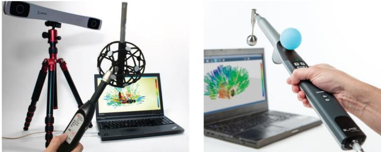
Abbildung 2.25: 3D-Schallintensitätssonde mit Infrarot-Positionserfassung (links) (Microflown Technologies, 2021b) und optischer Positionserfassung (rechts) (Janssens et al., 2013)
