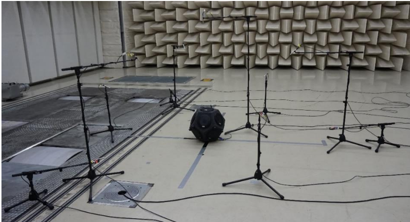
Abbildung 5.22: Messaufbau im Akustikrollenprüfstand des IPEK nach DIN EN ISO 3744
