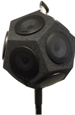
Abbildung 2.26: Dodekaeder Lautsprecher (Stratenschulte Messtechnik, 2021b)
