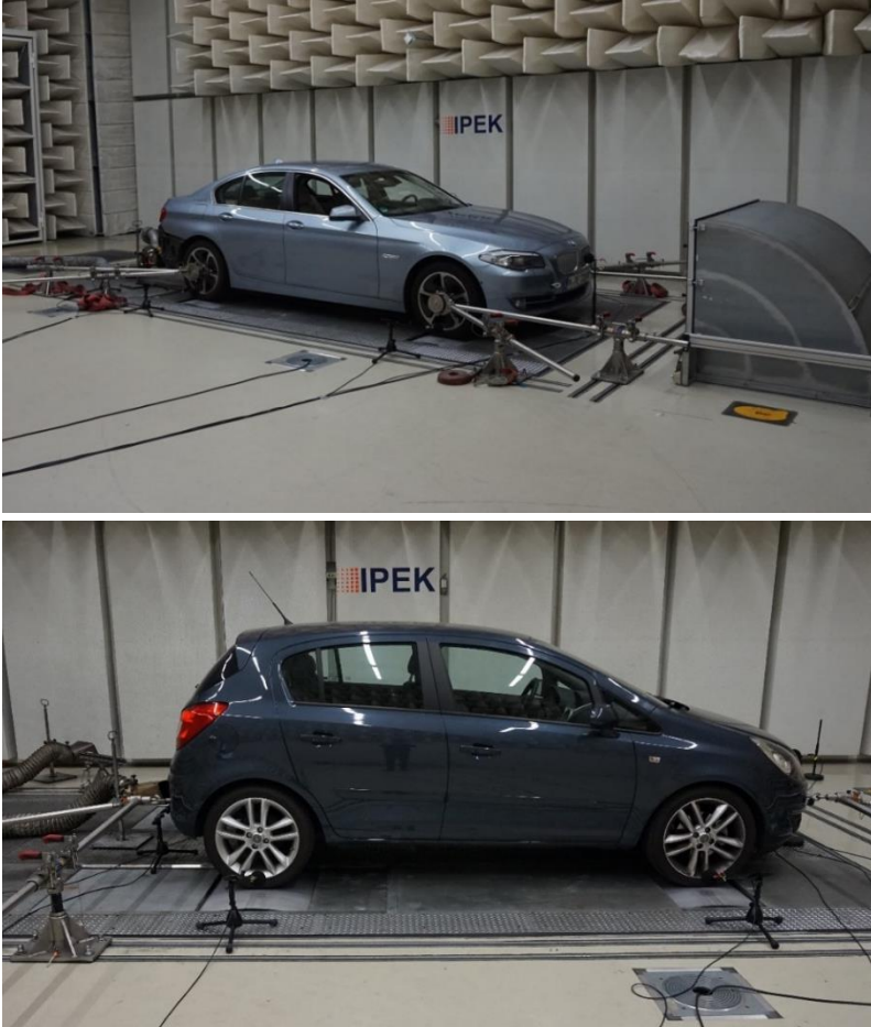
Abbildung 7.6: Messaufbau der TPA an den Versuchsfahrzeugen auf dem Akustikrollenprüfstand des IPEK
