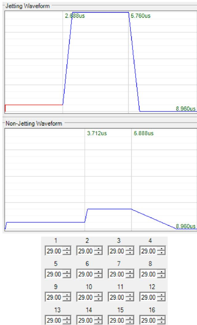
Abbildung 9.5: Druckparameter und Spannungsimpuls für die PLGA:Anisol Tinte in einer Dimatix 10pl Cartridge auf einem Fujifilm Dimatix DMP 2850. Die Druckkopftemperatur beträgt 34°C.
