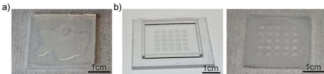
Abbildung 6.6: Aufnahmen a) der Silan-Lösung auf dem glatten Ecoflex-Substrat und b) der Gussform für das Ecoflex-Substrat mit eingravierten Flächen, sowie der Silan-Lösung auf dem Ecoflex-Substrat mit rauen Flächen. Adaptiert mit Erlaubnis aus Referenz <sup>[239]</sup>. © IOP Publishing. Alle Rechte vorbehalten.
