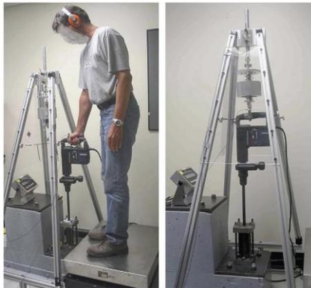
Abbildung 3.4: Durchführung der Verifizierung des entwickelten Hand-Arm-Modells (linkes Bild) sowie Hand-Arm-Modell mit Prüfstand (rechtes Bild) (Marcotte et al., 2010)
