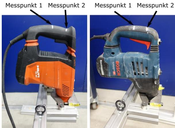
Abbildung D.4: Messpunkte 1 (Pos1) und 2 (Pos2) zur Bestimmung der Federsteifigkeit je Bohrhammer (links Bosch GBH 3-28 und rechts Hilti TE 30).
