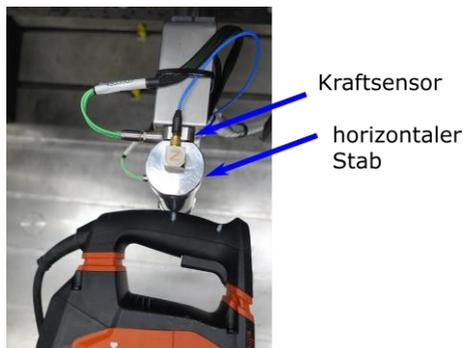
Abbildung D.3: Versuchsaufbau zur Bestimmung der Federsteifigkeit der Hauptgriffentkopplung beider Bohrhammer
