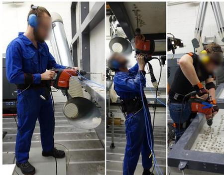
Abbildung 5.2: Beispielhafte Darstellung der von den Probanden eingenommenen Körperhaltung bei den drei Bohrrichtungen: horizontal (linkes Bild), vertikal nach oben (mittleres Bild), vertikal nach unten (rechtes Bild) (Uhl et al., 2019).
