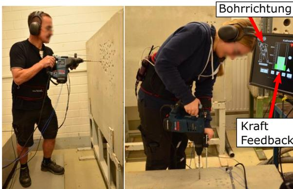
Abbildung 5.7: Exemplarische Abbildung der beiden Bohrrichtungen. Im linken Bild ist das horizontale und im rechten Bild das vertikale nach unten Bohren zu sehen. Zusätzlich ist im rechten Bild die Anzeige zur Vorgabe der Bohrrichtung sowie das visuelle Feedback der Vorschubkraft erkennbar. Diese wurde für eine übersichtlichere Darstellung im linken Bild entfernt. (Übersetzt von Uhl et al., 2021)
