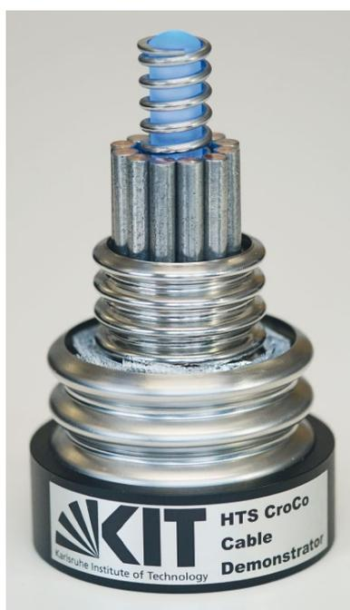
**Abb. 7** Dieses Gleichstromkabelmodell mit Hochtemperatur-Supraleitern der 100-kA-Klasse bei 20 K hat einen Außendurchmesser von nur 70 mm.
