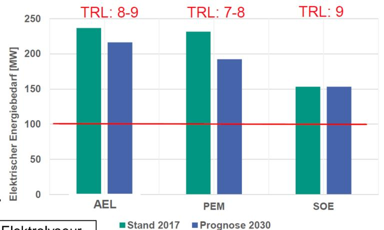
AEL: Alkalische Elektrolyse; PEM: Polymer Elektrolyte Membrane Elektrolyse; SOE: Festoxid-Elektrolyseur
