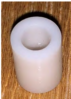
2234 ZrO 2 pellets OD=7.93 mm, ID=4.75 mm
