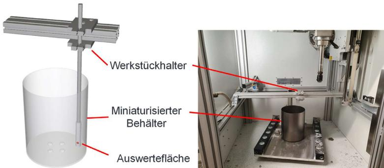
Abbildung 10: Darstellung des miniaturisierten Simulationsmodells sowie des realen Aufbaus in der Tauchgleitschleifmaschine.
