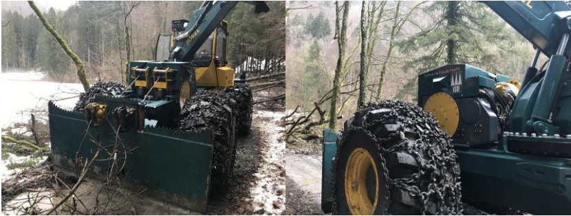
Abbildung 3.3: Winde in der Praxiserprobung auf Kranschlepper HSM 904ZL
