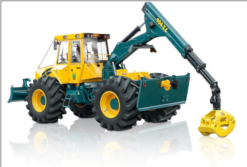
Abbildung 1.1: Forstspezial-Schlepper mit Rückekran und Winde, HSM 904ZL
