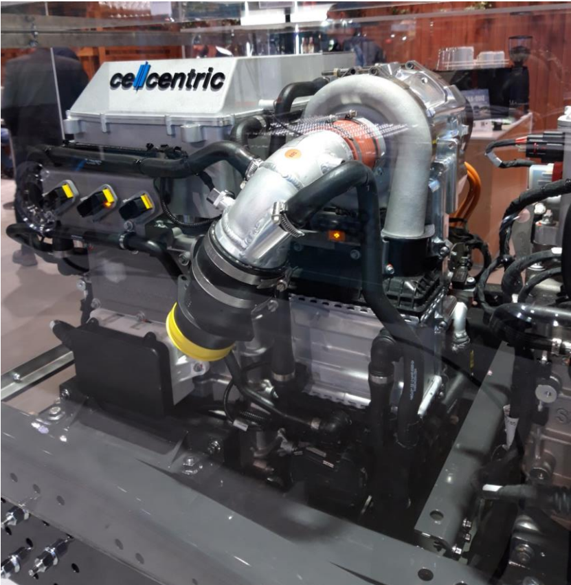
Abbildung 3.2: Brennstoffzelle für LKW mit Turboluftgebläse (Quelle: Autor)
