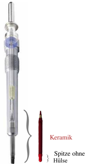
Abbildung 3.3 Durchsichtige Darstellung der Keramikglühkerze.
