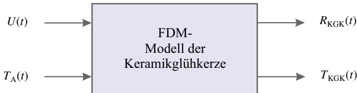
Abbildung 5.6 Vereinfachtes Glühkerzenmodell. U(t) : Spannung, T_A(t) : Temperatur in unmittelbarer Umgebung der Kerze, R_{\text{KGK}}(t) : Kerzenwiderstand sowie T_{\text{KGK}}(t) : Kerzentemperatur.
