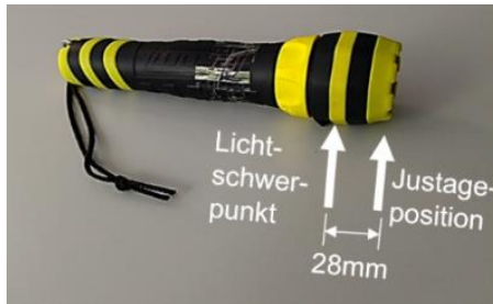
Abbildung 7.49: Unterschied zwischen realem Lichtschwerpunkt und der Messgerätjustageposition.
