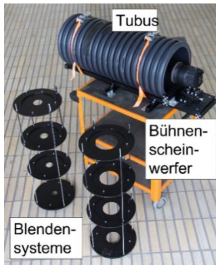
Abbildung 5.11: Der für die Aufnahme der SVFs verwendete Lichtfinger inklusive der Tubussysteme der Raum- und Messschirm-region.
