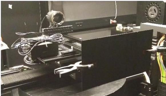
Abbildung 3.9: Konstruierte Lichtquelle bestehend aus dem Bühnenscheinwerfer X4-Atom, dessen optisches Linsensystem auf einen Öffnungswinkel von 34^\circ eingestellt ist. Ein Teil der Lichtverteilung wird durch eine Blende abgeschattet um den Raumstreulichteinfluss untersuchen zu können.
