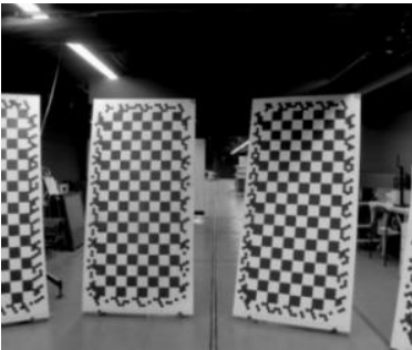
Abbildung 4.24: 2x1 Meter große Schachbrettmuster des verwendeten Kamerakalibrieralgorithmus.
