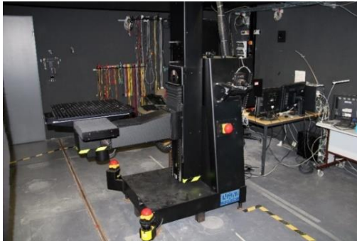
Abbildung 2.3: Typ-A Goniophotometer GO-H 1660 mit zwei Rotationsachsen und drei Translationsachsen.
