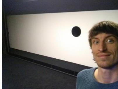
Abbildung 3.8: Teil der Messwand in 10 m Entfernung mit einem Loch entlang der optischen Achse des Goniometers für den Photometerkanal. Der Autor ist zum Größenvergleich mit im Bild.
