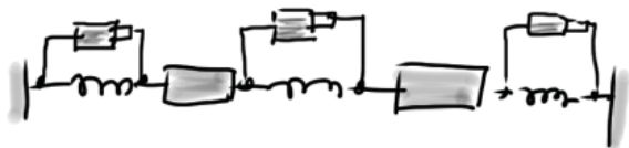
Abb. 7.7 Federschwinger mit Dämpfung. Eine der Eigenschwingungen ist stärker gedämpft als die andere.
