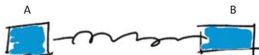
Abb. 3.7 Die Feder steht unter Zugspannung. Vom rechten zum linken Körper fließt Impuls.
