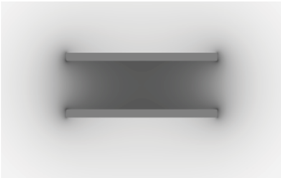
Abb. 6.8 Darstellung des Feldes einer Spule mit Grautönung
