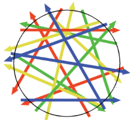
Abb. 8.3 Alle Farben, alle Richtungen. Das Licht ist zeitlich und räumlich inkohärent.
