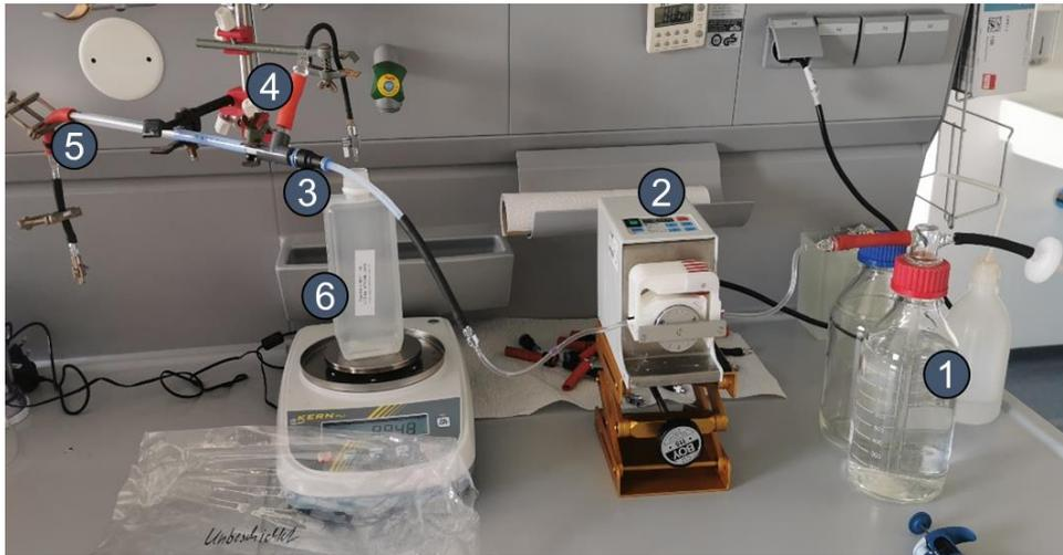
Abbildung 3-13 Aufbau der Filtrations-Versuche mit Einzelfaser-Membranen. 1) Reservoir mit ARG-Fragmenten, 2) Schlauchpumpe, 3) Zulauf zum Membranmodul, 4) Ablauf des Filtrats nach Innen-nach-Außen-Filtration, 5) Ablauf für Spülung (Durchfluss durch Kapillar-Innenraum), 6) Reservoir zur Sammlung der Filtrat-Fraktion mit Aufzeichnung der Volumen-Zunahme.
