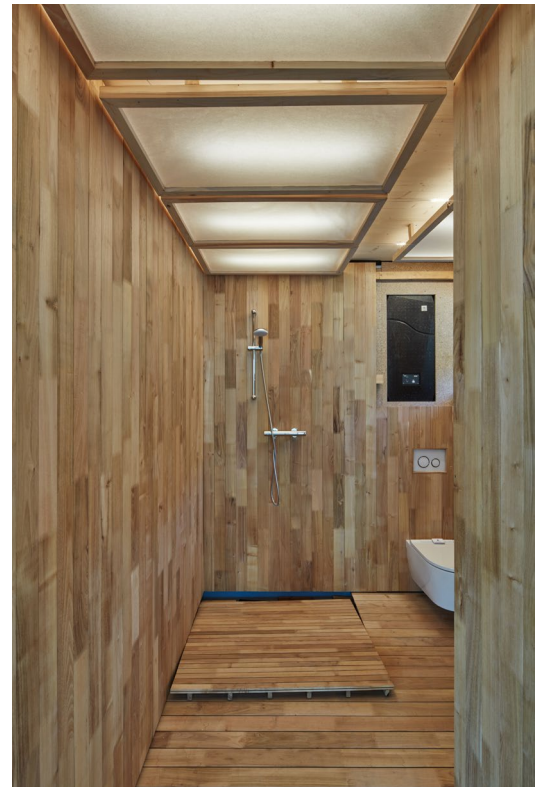
Abb. 305: Badezimmer mit herausnehmbarem Boden, Oberflächen ohne mineralische Baustoffe
