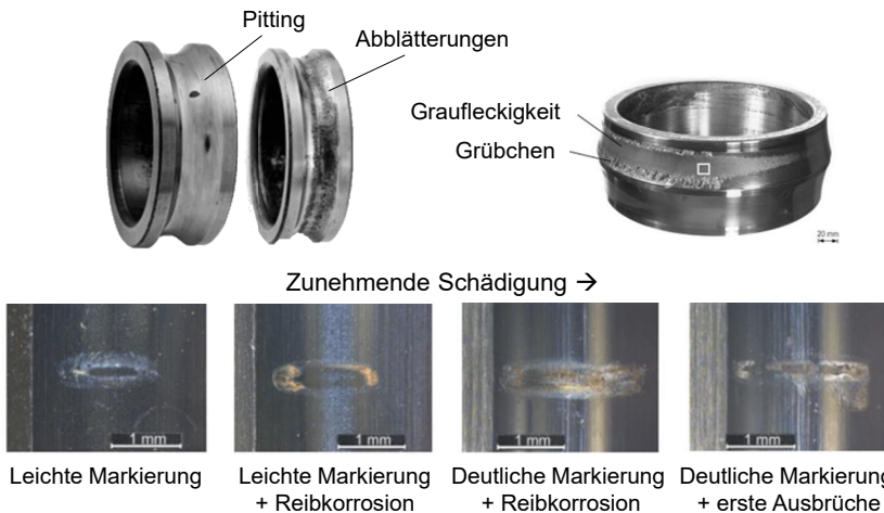
Abbildung 2-9 Sich gegenseitig beeinflussende Verschleißmechanismen. Oben links: Innenring eines Kugellagers (Schaeffler 2000) 10 , oben rechts: Pendelrollenlager (Sommer, Heinz & Schöfer 2018), unten: Kugelgewindetriebspindel (Münzing 2017).
