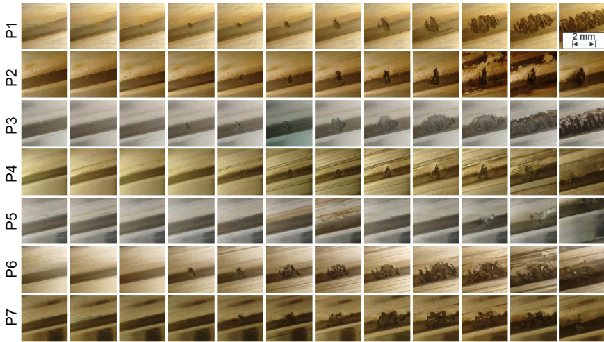
Abbildung 6-11 Beispiele für die Entwicklung unterschiedlicher Pittings (P1–P7) über die Lebensdauer von Komponenten hinweg nach (Schlagenhauf & Scheurenbrand et al. 2022). Erste Spalte: Bilder zu Versuchsbeginn; letzte Spalte: Bilder bei Lebensdauerende. Dazwischen wurden Beispiele gleichmäßig aus den Bilddaten gezogen. P2, P3 und P5 zeigen Partikel auf der Spindel, bevor ein Pitting entsteht.
