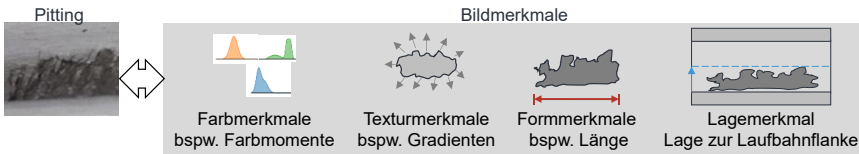
Abbildung 6-23 Qualitative Abbildung der Bildmerkmale am Beispiel des Pittings.
