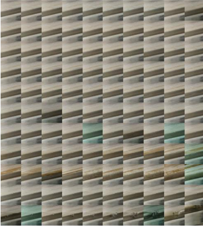
Abbildung 0-6 Beispiele von Pitting-Verläufen, zusammengefasst dargestellt in Abbildung 6-12. Lebensdauer zeilenweise zunehmend. Erstes Bild entspricht 0 % Lebensdauer. Zwischen dem ersten und zweiten Bild sind Bilder zwecks der Übersichtlichkeit nicht dargestellt, da keine Veränderung im Bild zu erkennen ist. Zweites bis letztes Bild zeigen die vollständige Entwicklung des jeweiligen Pittings.
