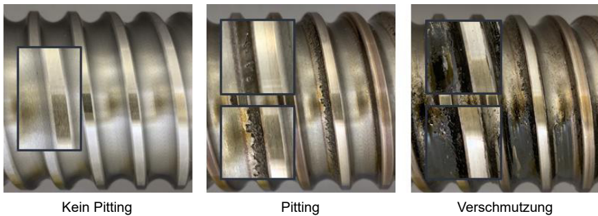
Abbildung 6-24 Markante Zustände der Laufbahn des KGTs (A_Hofmann 2021).
