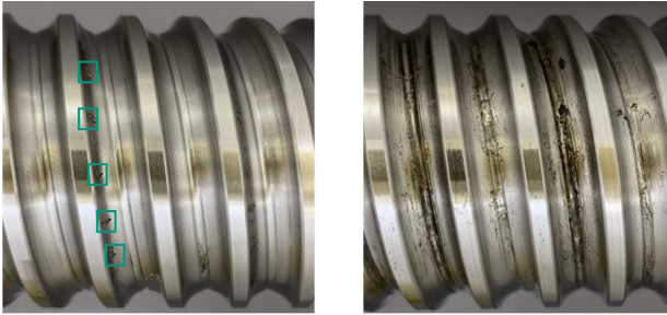
Abbildung 5-8 Beispielhafte Aufnahmen des Kamerasystems. Links: Oberfläche mit Schädigungen; rechts: nicht geschädigte Oberfläche mit betriebsbedingten Verunreinigungen.
