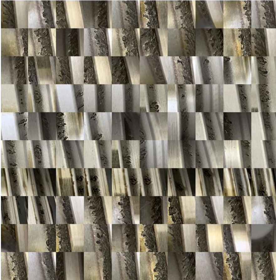
Abbildung 0-4 Ausschnitt aus der Menge der Bilddaten mit Pitting.
