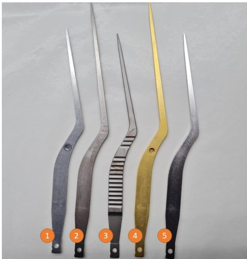
**Abbildung 17: Exemplarischer Galvanikprozess - Unterschiedliche Beschichtungsstadien von OP-Pinzetten.**
