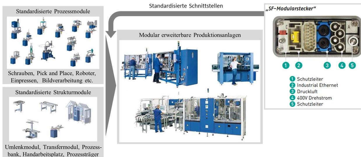
**Abbildung 4: Exemplarische Konfiguration einer Produktionsanlage aus standardisierten Prozess- und Strukturmodulen nach [KLE14, FN09].**
