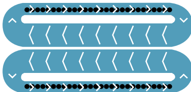
Abb. 2.39 Der x-Impulsstrom fließt im Feld im Innern der Spule von rechts nach links und durch das Spulenmaterial wieder zurück nach rechts.
